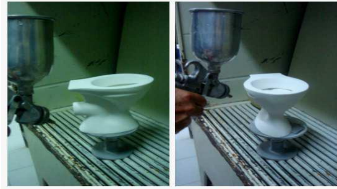
Şekil 3.12 Püskürtme yöntemi ile sırlama işlemi.
