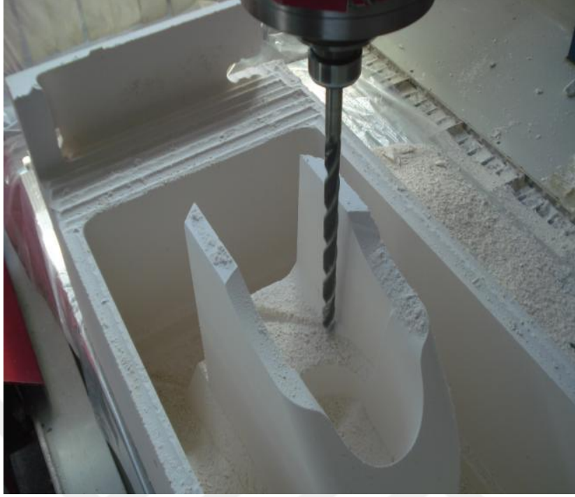
Şekil 3.7 Model kalıbın CNC’ de işlenmesi.
