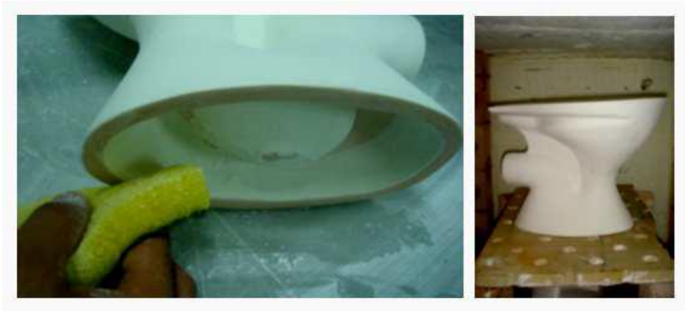
Şekil 3.13 Sır ayağındaki sır tabakasının silinme işlemi (Reed 1995).
