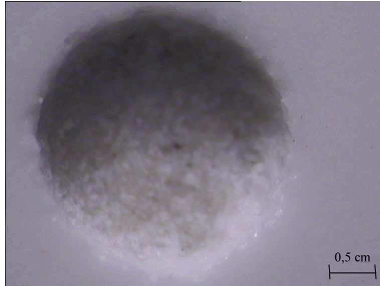
Şekil 6.68. Nd-YAG lazer kullanılarak açılan delik
