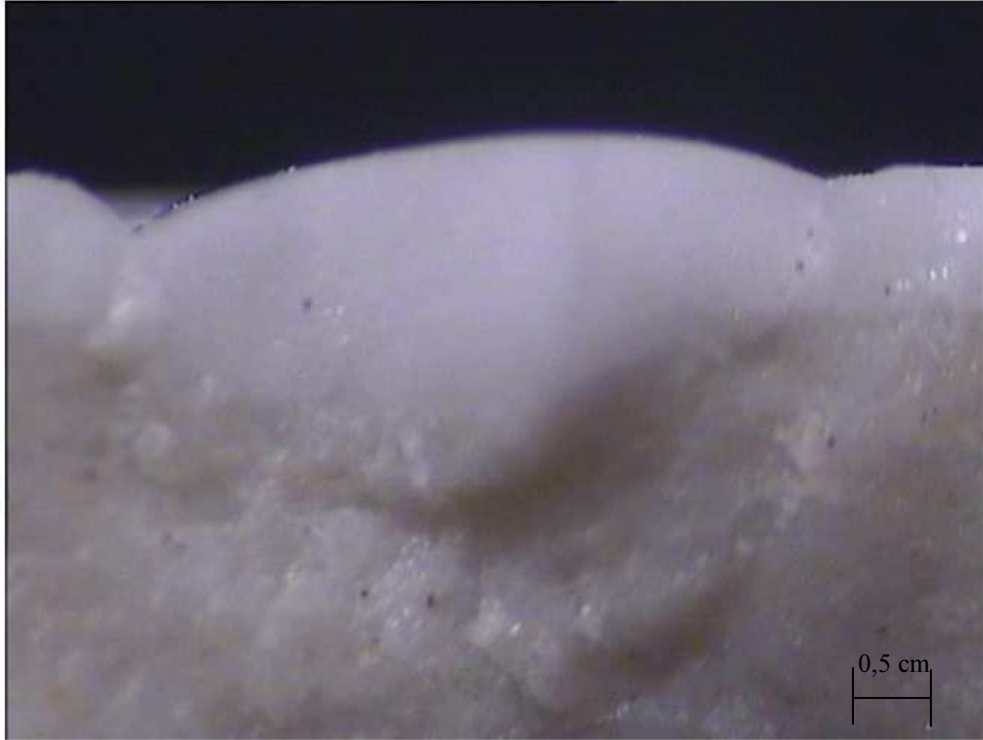
Şekil 6.86. Tamir bölgesi kesitinin optik mikroskop görüntüsü
