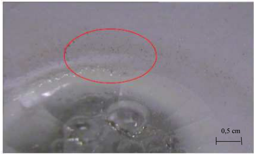
Şekil 6.75. CO 2 gazı birikmesi (Black core)
