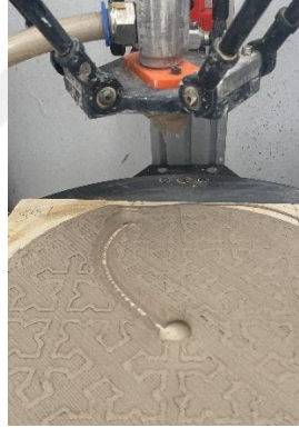
Görsel 4.5. Kalibrasyon ayarı yapılmadan başlatılan baskıda yaşanan dip dalma sorunu
