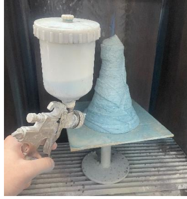
Görsel 4.36. ‘‘Deniz Mavisi’’ pistole yardımıyla astarlama aşaması
