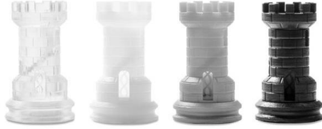
Görsel 3.6. Farklı reçineler kullanılarak SLA yöntemi ile basılmış formlar
