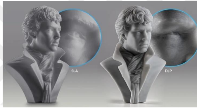
Görsel 3.9. SLA ve DLP yöntemleri ile basılmış ürünlerin karşılaştırılması
