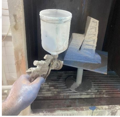
Görsel 4.15. Pistole yardımıyla astarlanan "Yaşam Üçgeni"
