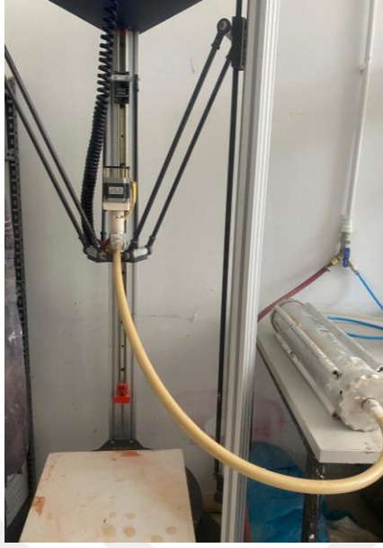
Görsel 4.1. Gerekli bağlantıları tamamlanarak baskıya hazır hale getirilen üç boyutlu seramik yazıcı
