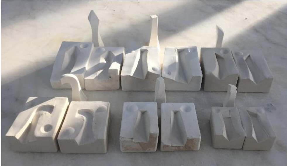
Görsel 3.19. Pla modellerin kalıp çekirdeği olarak kullanılmasıyla üretilen satranç taşlarının alçı kalıpları
