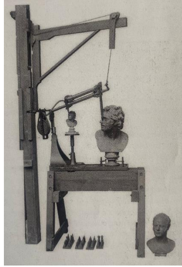
Görsel 3.3. Cheverton 'un patentini alarak geliştirdiği heykel kopyalama makinesi, 1884, Londra, İngiltere
