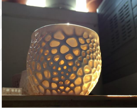
Görsel 3.23. SLA yöntemi kullanılarak üretilmiş porselen kupa
