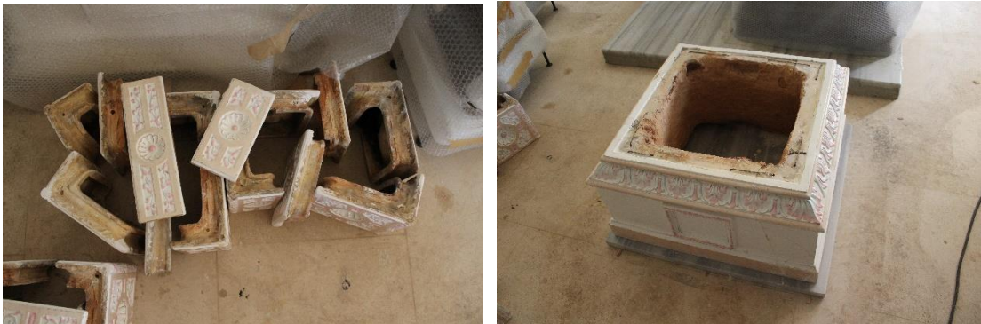
Görsel 3.16. Bütünlüğü Bozulmuş Çini Sobanın Parça Tasnifi ve Birleştirme, Dolmabahçe Sarayı Çini Soba Restorasyon Atölyesi (Fotograf: Kamuran Ak, 2015)
