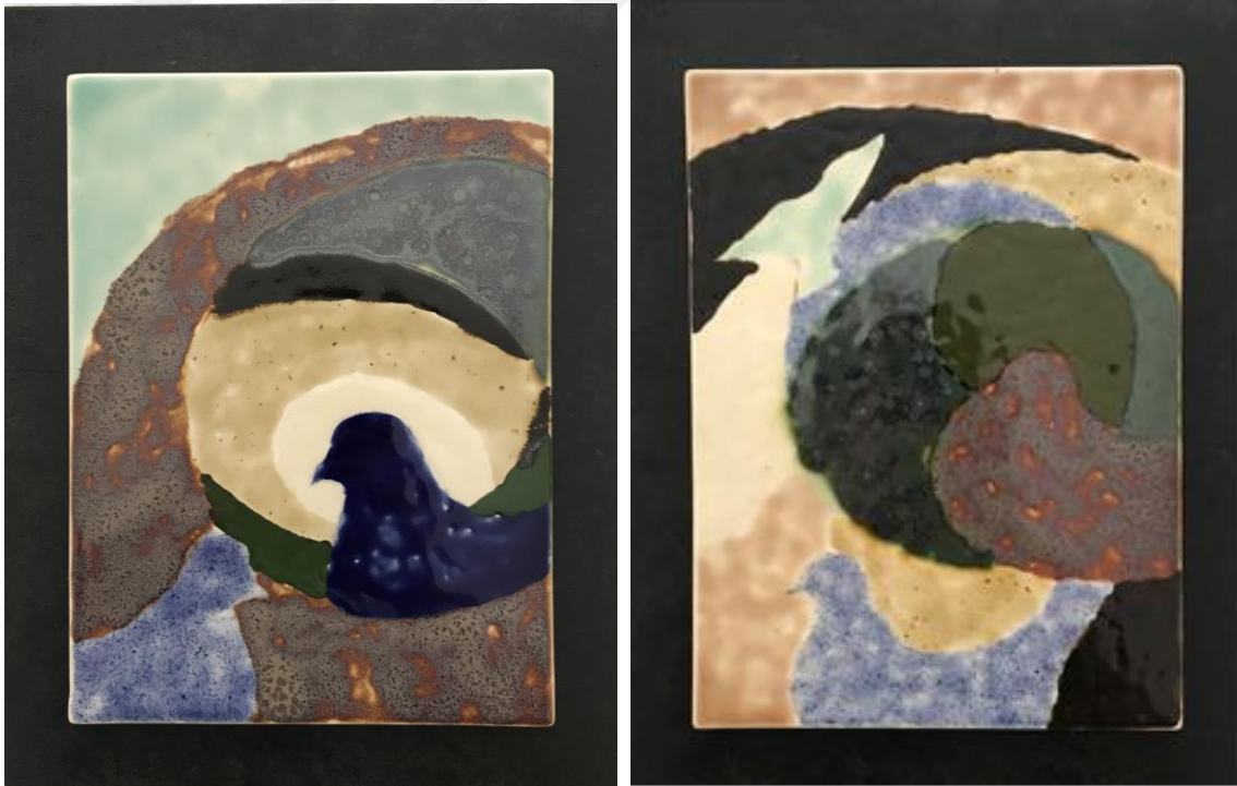
Görsel 4.3. 1200°C Sıcaklıkta 19, 20, 21, 22, 24, 25, 26, 27, 29 Numaralı Sırlarla Renklendirilmiş Formlar
