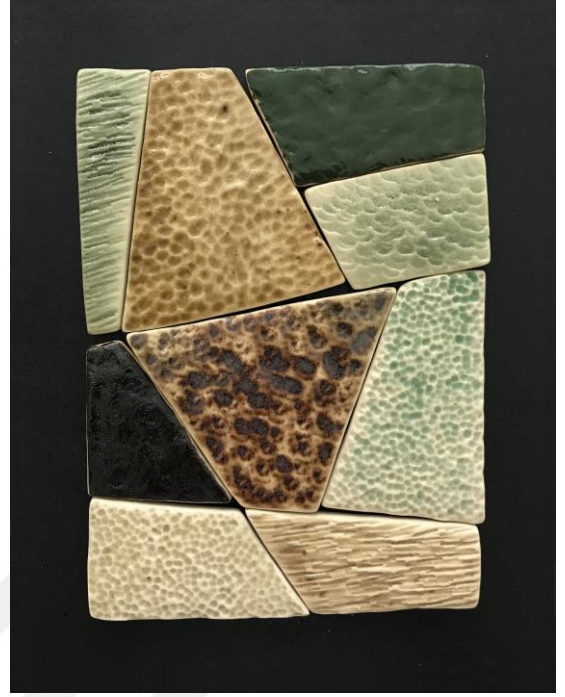
Görsel 4.4. 1200°C Sıcaklıkta 20, 22, 25, 26, 28 Numaralı Sırlarla Renklendirilmiş Formlar
