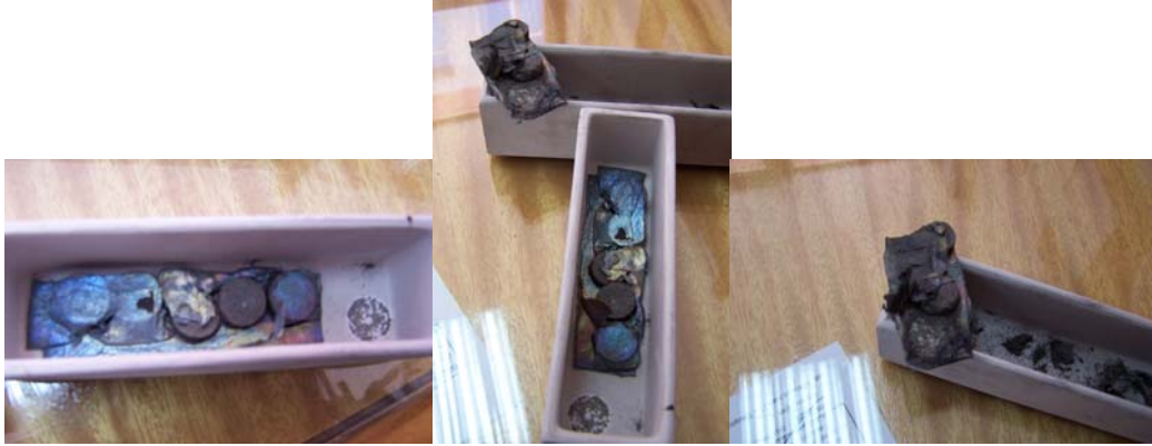
Şekil 4.1. Çinko tarafından ıslatılmayan pelletler
