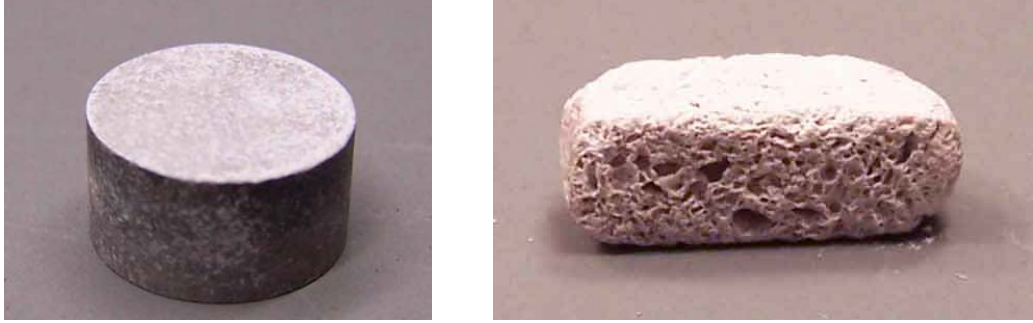
Şekil 3.4. Bağlayıcı uçurulmadan önce ve sonra pelletin durumu
