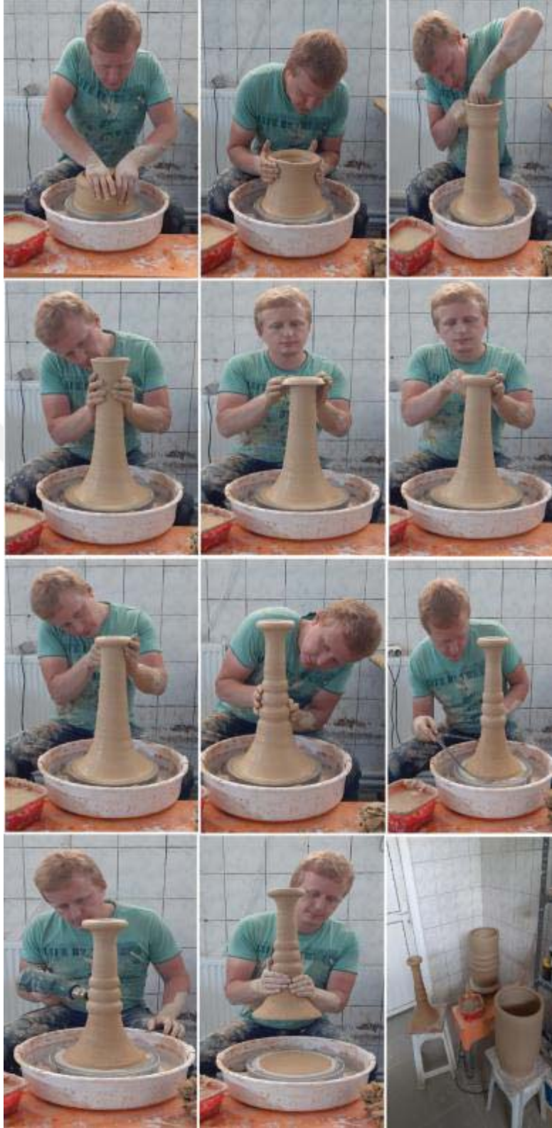
Resim 3.60. Büyük formların yapım aşamaları, parça ekleme usulü, üst parçanın yapımı Fotoğraf: Aybüke Yıldırım-2019
