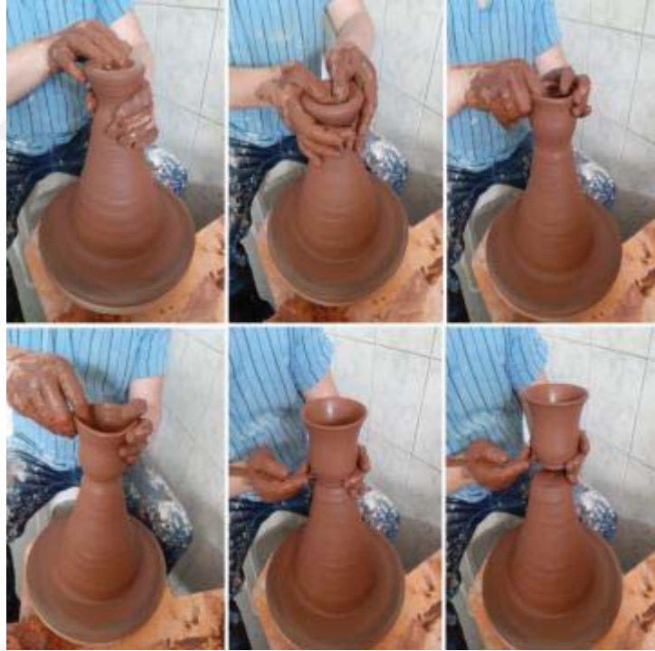
Resim 3.54. Büyük çamur kütlesi üzerinde çok sayıda form yapım aşamaları Fotoğraf: Aybüke Yıldırım-2019
