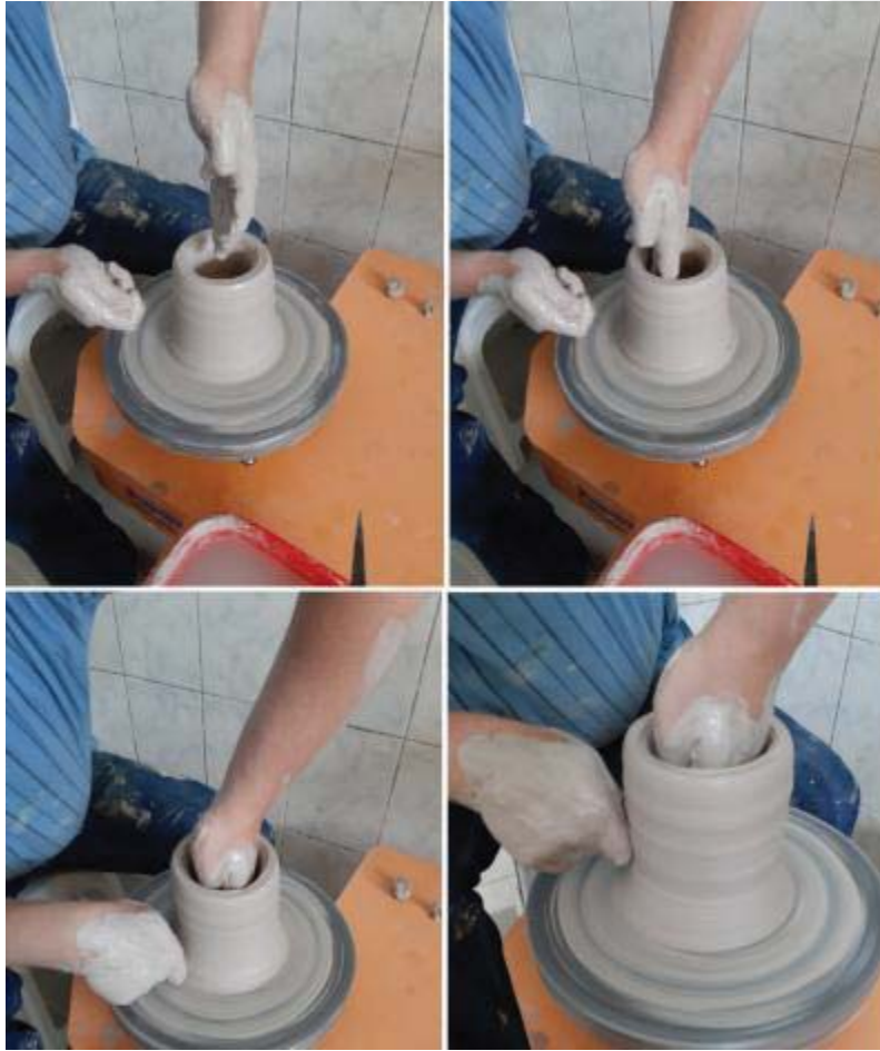
Resim 3.10. Silindir formu yapım aşamaları - Fotoğraf: Aybüke Yıldırım-2019
