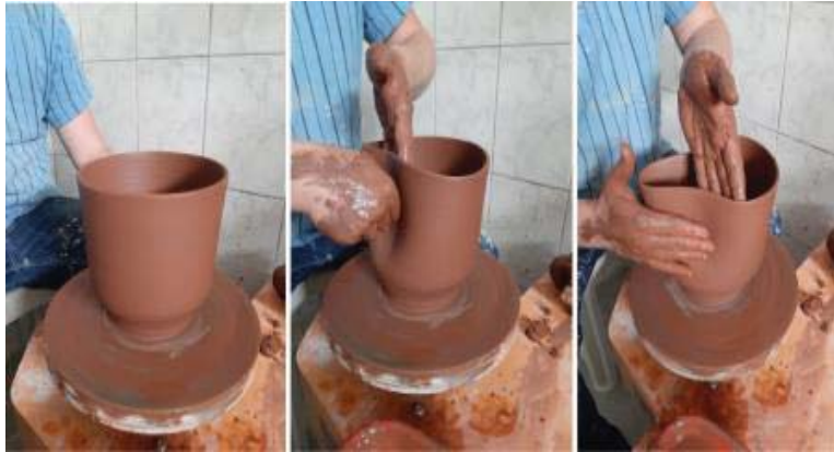
Resim 3.70. Tornada şekillendirilen seramiklerin farklı biçimlere dönüştürülmesi Fotoğraf: Aybüke Yıldırım-2019
