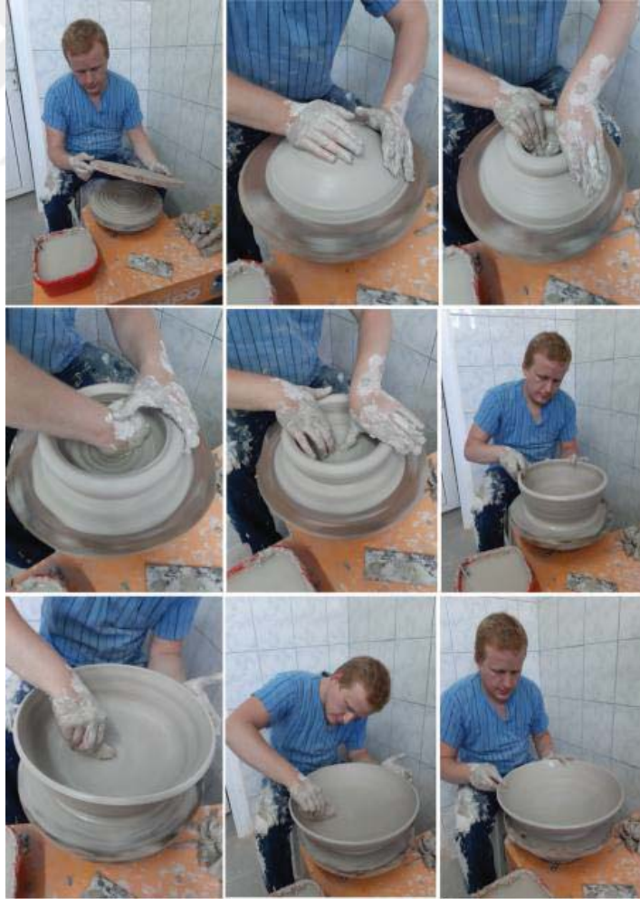
Resim 3.27. Tabak formu yapım aşamaları - Fotoğraf: Aybüke Yıldırım-2019
