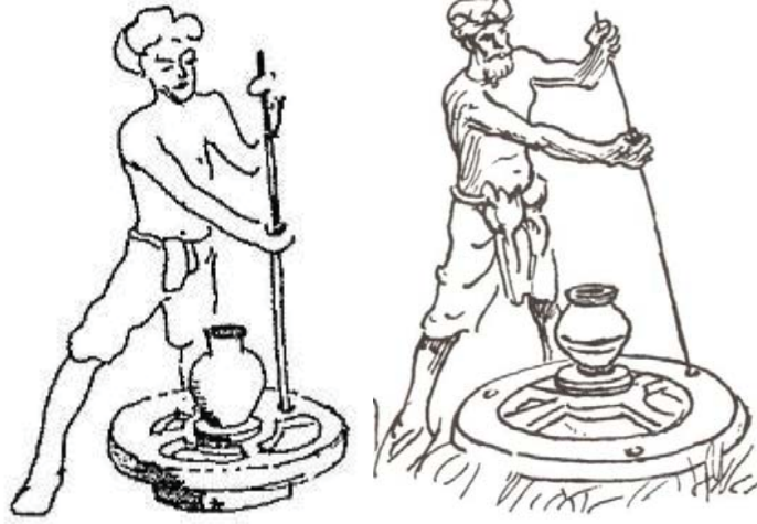
Resim 2.10. Tekerleğe benzer şekilde yapılmış, ustanın veya yardımcısının kullandığı uzun bir çubuk ile döndürülebilen ilkel el tornası örnekleri, temsili çizim – Leach, 1976, s.67
