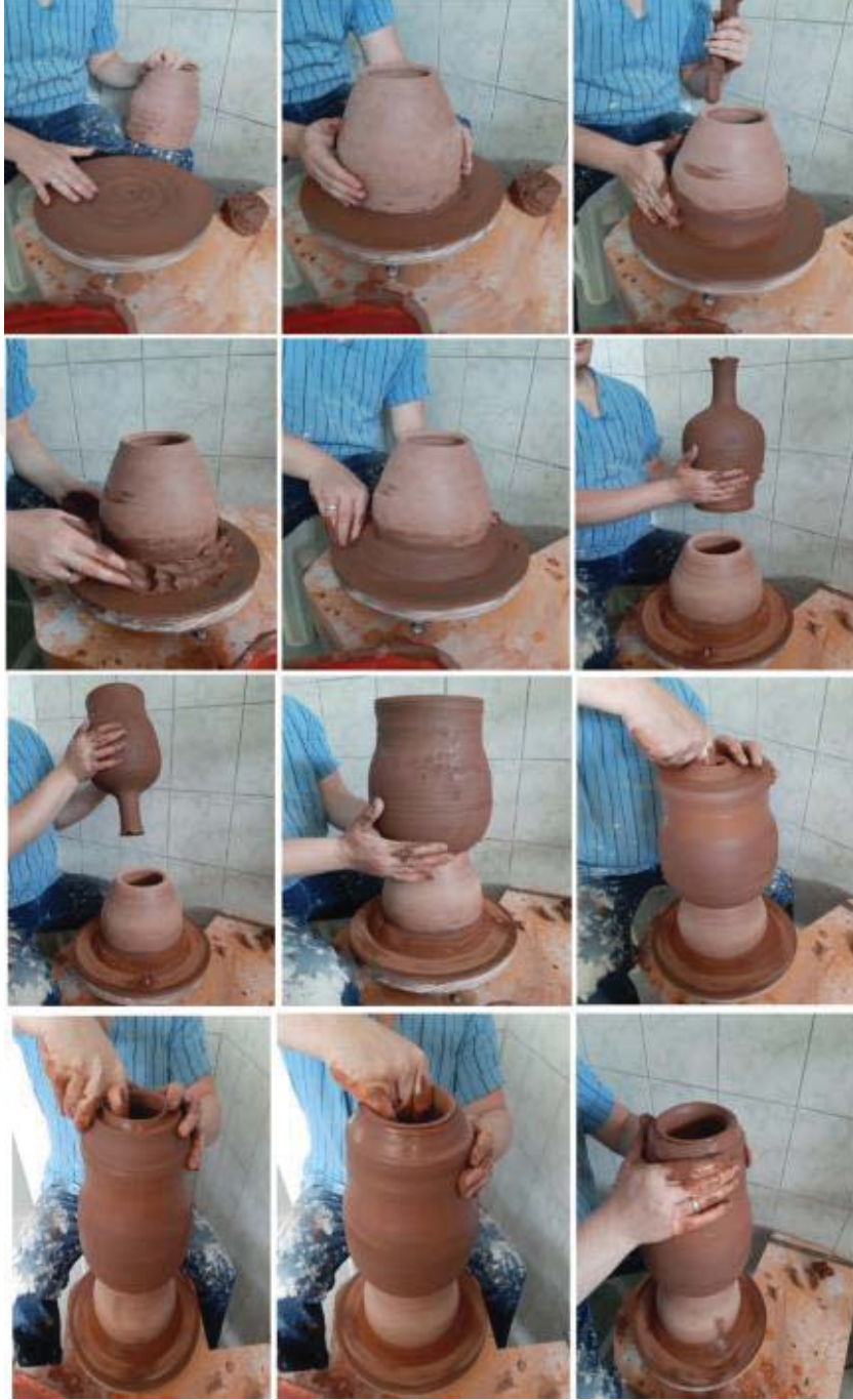
Resim 3.50. Amfora formu yapım aşamaları - Fotoğraf: Ayb ke Yıldırım-2019
