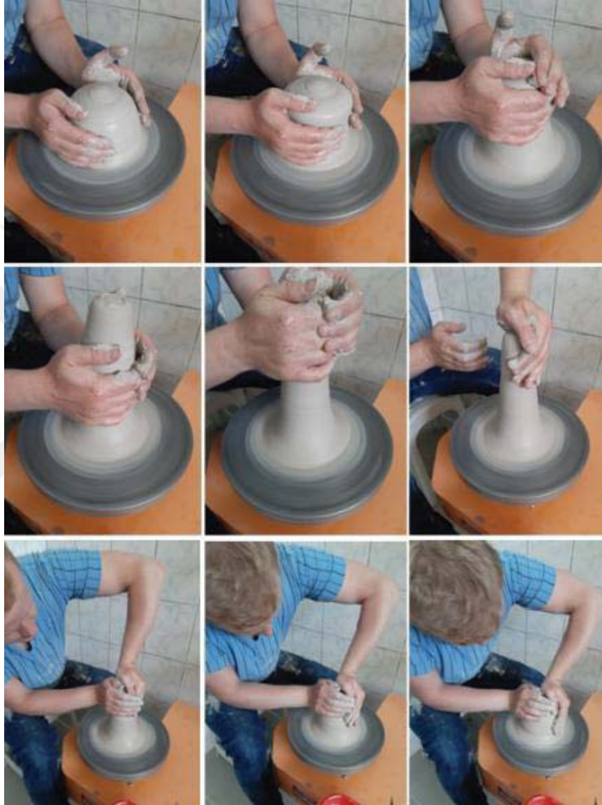
Resim 3.6. Çamuru merkeze alma, ellerin saat üç-dokuz konumu, kaldırıp-indirme, çamuru sıkıştırma Fotoğraf: Aybüke Yıldırım-2019
