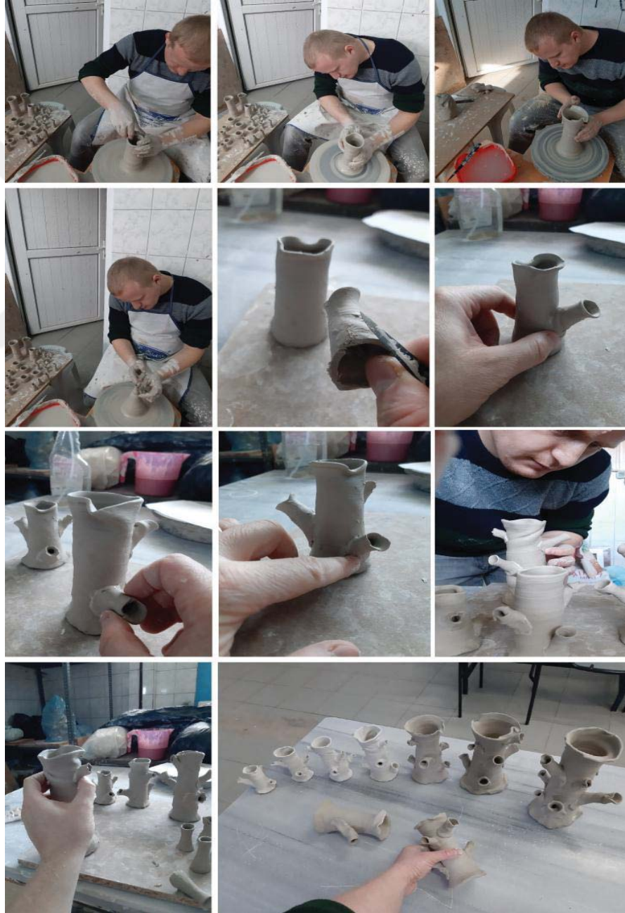
Resim 6.9. Uygulama 3 yapım aşamaları - Fotoğraf: Burak Yıldırım-2021
