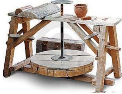
Resim 2.17. Şekillendirme aletleri, su kabı vb. koyulması için masa ilavesi yapılmış ilk ayak tornaları örneği - https://tr.pinterest.com/pin/132363676533579513 - 2019
