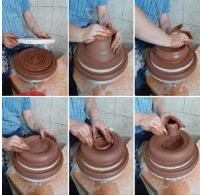
Resim 3.41. Halka(simit) formu yapım aşamaları - Fotoğraf: Aybüke Yıldırım-2019
