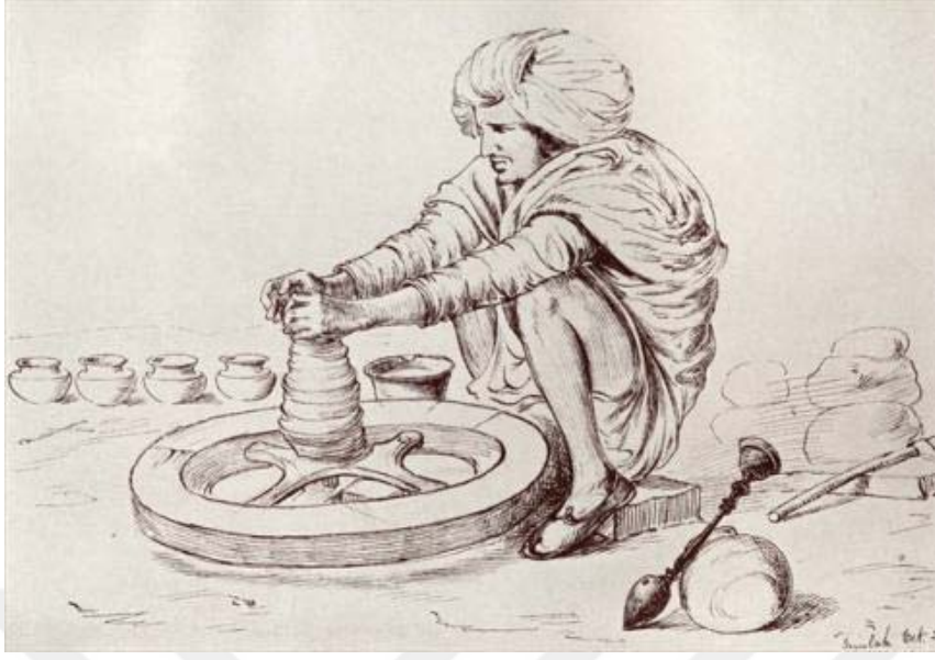
Resim 2.8. Tekerleğe benzer şekilde yapılmış ve bir mil yardımıyla alt kaideye geçirilmiş ilkel el tornası örneği - Yıldırım, 2016, s.6
