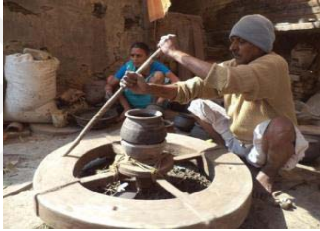
Resim 2.11. Ustanın veya yardımcısının kullandığı uzun bir çubuk ile döndürülebilen ilkel el tornası - https://tr.pinterest.com/pin/132363676533579513 - 2019
