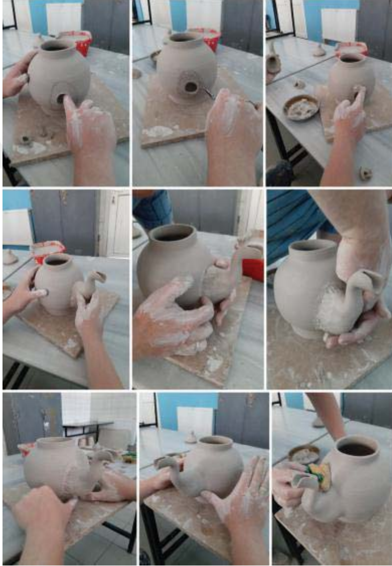
Resim 3.36. Gövde üzerine emzik yapıştırma aşamaları - Fotoğraf: Aybüke Yıldırım-2019
