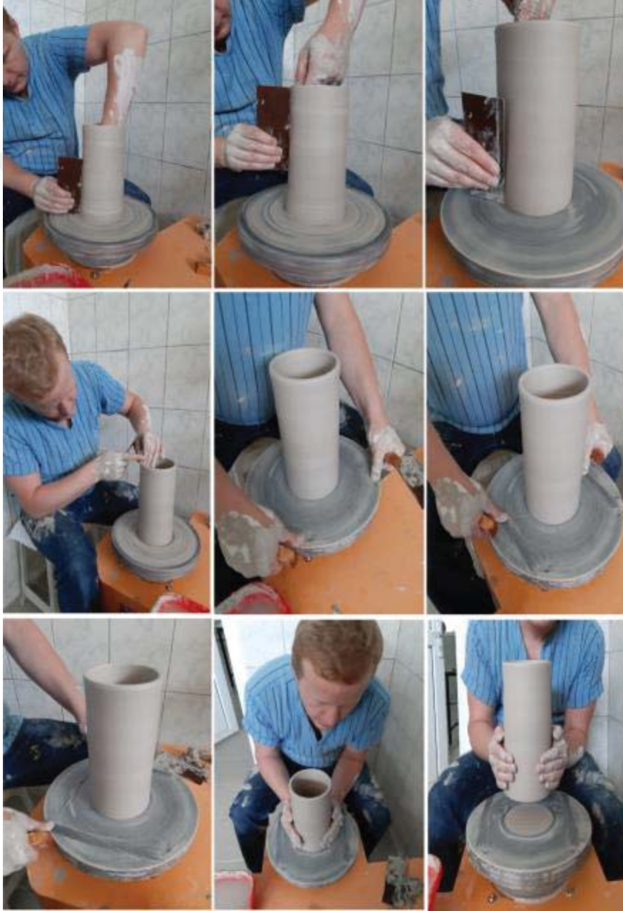
Resim 3.12. Silindir formu yapım aşamaları - Fotoğraf: Aybüke Yıldırım-2019
