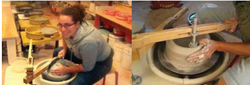
Resim 2.44. Torna üzerinde kütle halindeki çamuru merkezleme ve içini oyma aleti – StrongArm https://www.strongarmpotterytools.com – 2019
