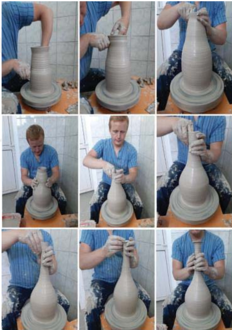
Resim 3.21. Vazo formu yapım aşamaları - Fotoğraf: Aybüke Yıldırım-2019
