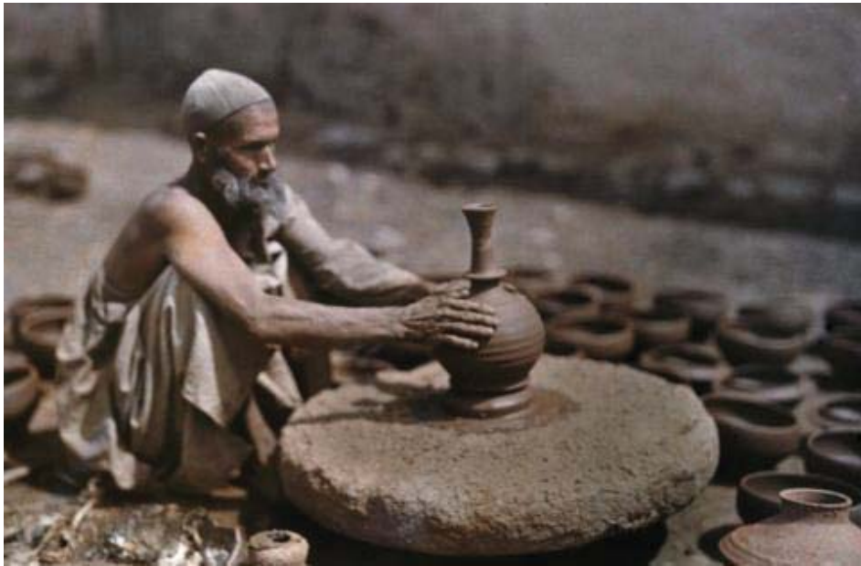
Resim 2.7. Tekerleğe benzer şekilde taştan yapılmış ve bir mil yardımıyla alt kaideye geçirilmiş ilkel el tornası – Yıldırım, 2016, s.6
