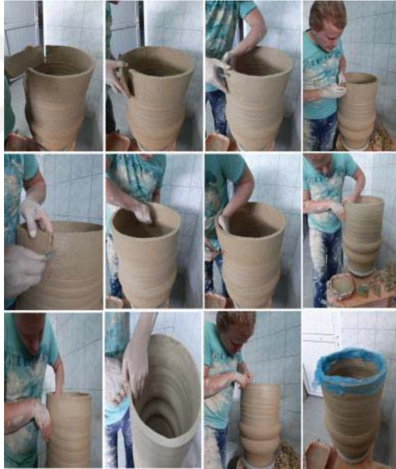
Resim 3.65. Büyük formların yapım aşamaları, sucuk/plaka ekleme usulü Fotoğraf: Aybüke Yıldırım-2019
