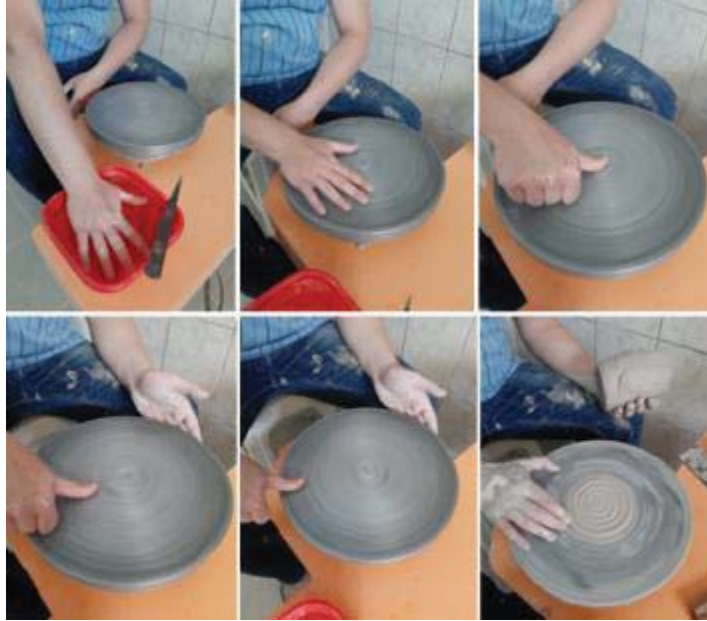
Resim 3.3. Torna tablasının çamurun yapıştırılması için en uygun olan nemli hale getirilmesi – Fotoğraf: Aybüke Yıldırım-2019
