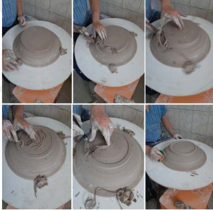
Resim 3.72. Tornada şekillendirilen seramiklerin tıraşlanması ve dip alma, tabak formu Fotoğraf: Aybüke Yıldırım-2019
