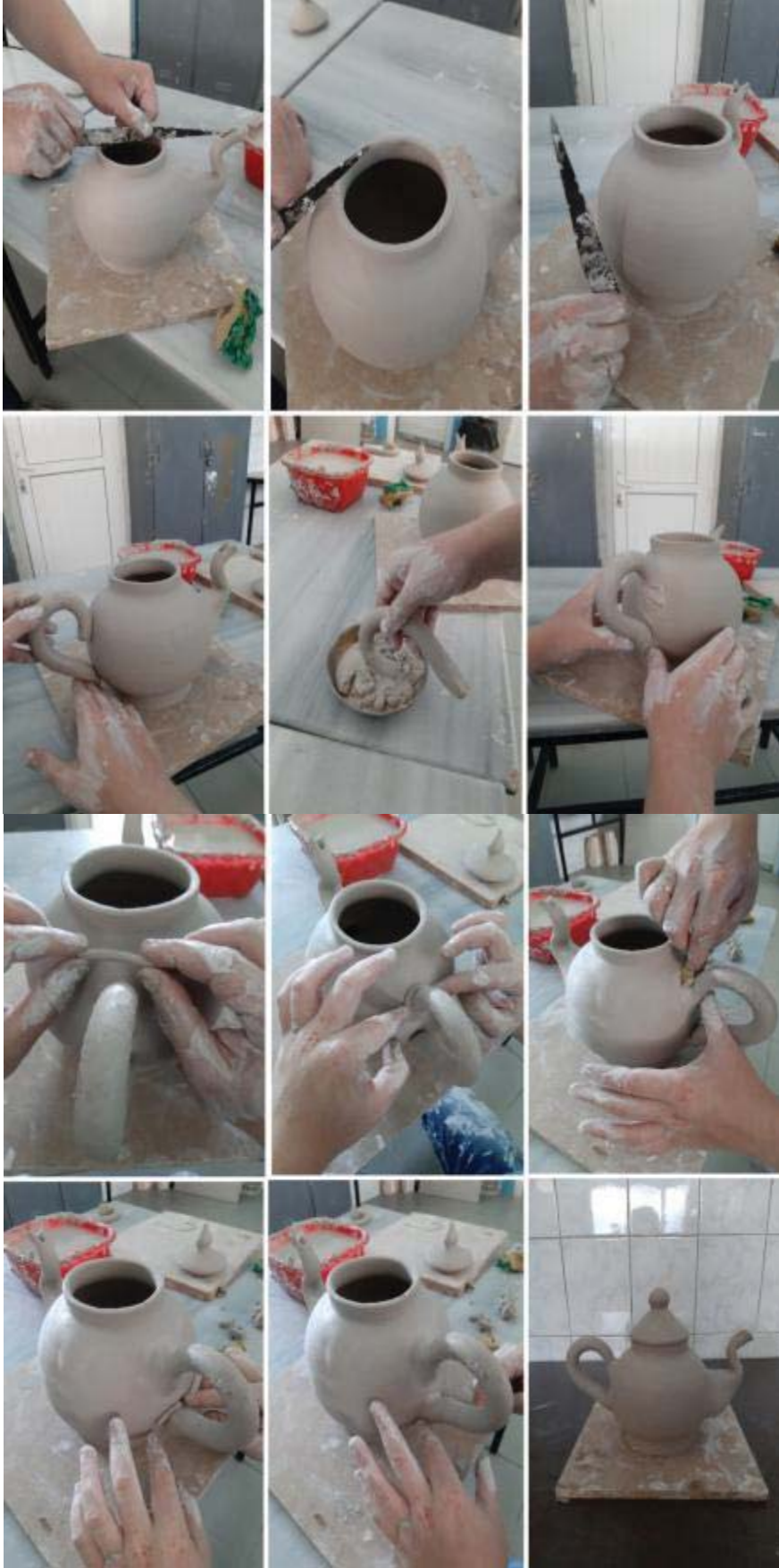
Resim 3.40. Gvde zerine kulp yapıştırma aşamaları - Fotoğraf: Aybke Yıldıırım-2019
