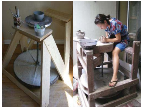
Resim 2.18. Şekillendirme aletleri, su kabı vb. koyulması için masa ilavesi ve oturma düzeneği yapılmış ayak tornaları örnekleri - https://tr.pinterest.com/pin/81064862012566940 - 2019
