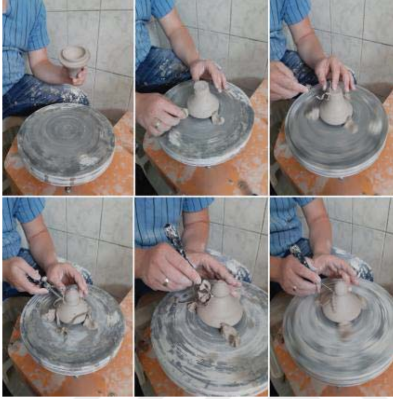
Resim 3.32. Çaydanlık kapak formu yapım aşamaları - Fotoğraf: Ayb ke Yıldırım-2019
