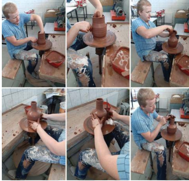
Resim 3.23. Vazo formu yapım aşamaları – ayak tornası kullanım örneği - Fotoğraf: Aybüke Yıldırım-2019
