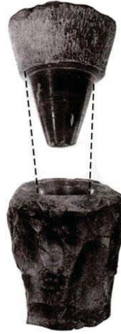
Resim 2.6. Bazalt taştan yapılmış ilkel torna – Speight ve Toki, 2004, s.19
