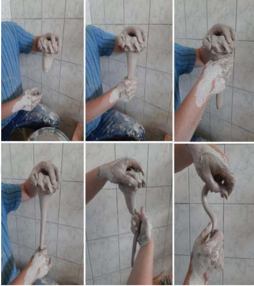
Resim 3.38. Kulp formu yapım aşamaları(ikinci yöntem) - Fotoğraf: Aybüke Yıldırım-2019
