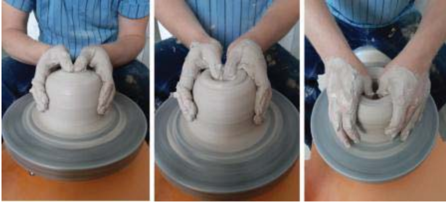
Resim 3.8. Silindir yapımı - tornaya yapıştırılıp merkezlenen kütle halindeki çamurun içini oyma - Fotoğraf: Aybüke Yıldırım-2019
