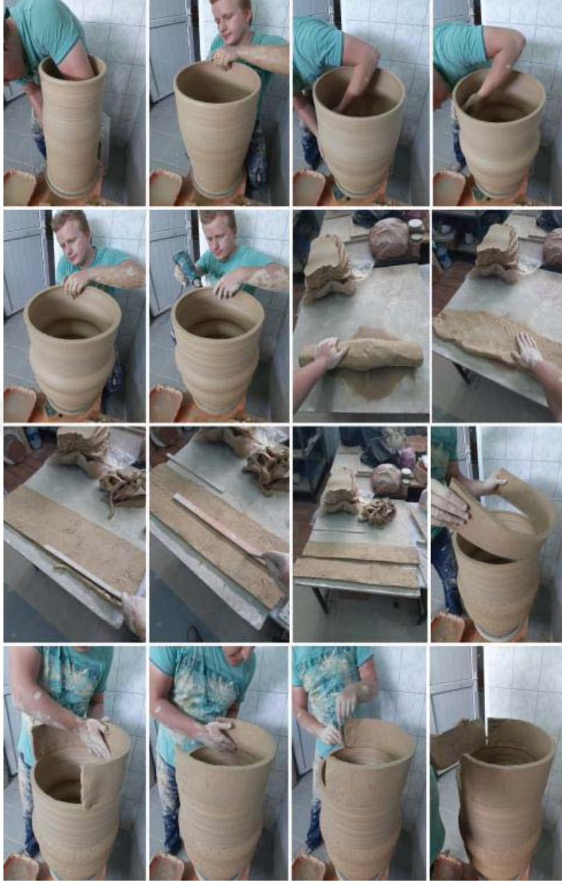
Resim 3.64. Büyük formların yapım aşamaları, sucuk/plaka ekleme usulü, ilk/alt parçanın çekilmesi Fotoğraf: Aybüke Yıldırım-2019
