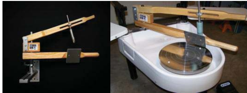
Resim 2.43. Torna üzerinde kütle halindeki çamuru merkezleme ve içini oyma aleti – StrongArm https://www.strongarmpotterytools.com - 2019
