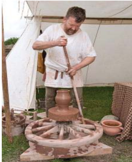
Resim 2.12. Ustanın veya yardımcısının kullandığı uzun bir çubuk ile döndürülebilen el tornası örneği https://tr.pinterest.com/pin/132363676533579514 - 2019
