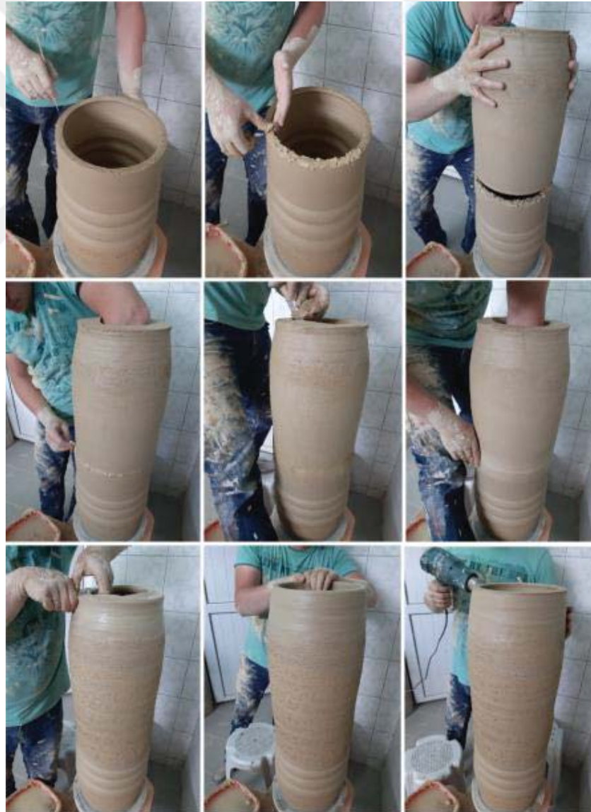
Resim 3.61. Büyük formların yapım aşamaları, parça ekleme usulü, parçaların birbirine eklenmesi Fotoğraf: Aybüke Yıldırım-2019
