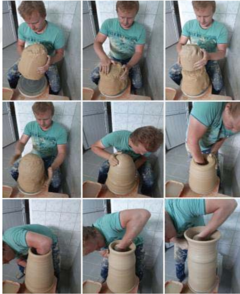
Resim 3.63. Büyük formların yapım aşamaları, sucuk/plaka ekleme usulü, ilk/alt parçanın çekilmesi Fotoğraf: Aybüke Yıldırım-2019
