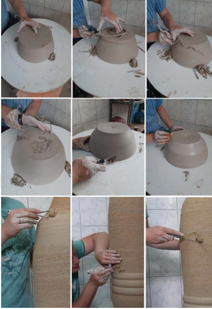
Resim 3.74. Tornada şekillendirilen seramiklerin tıraşlanması ve dip alma Fotoğraf: Aybüke Yıldırım-2019
