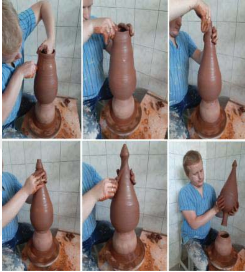
Resim 3.51. Amfora formu yapım aşamaları - Fotoğraf: Aybüke Yıldırım-2019
