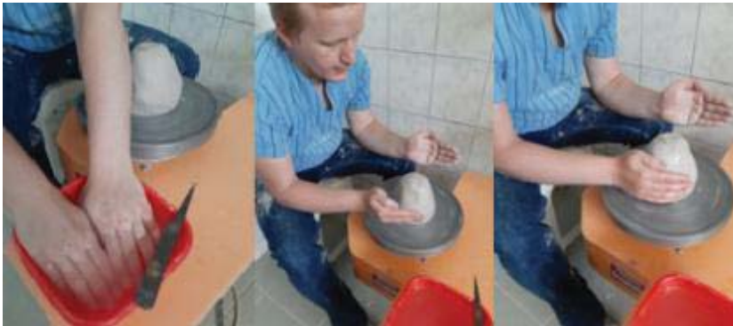
Resim 3.5. Ellerin ıslatılması ve çamura dokunma biçimi – Fotoğraf: Aybüke Yıldırım-2019
