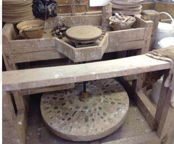
Resim 2.20. Ortalama 20. yüzyıl sonlarına kadar en sık kullanılan ayak tornası örneği – https://tr.pinterest.com/pin/81064862012566940 - 2019
