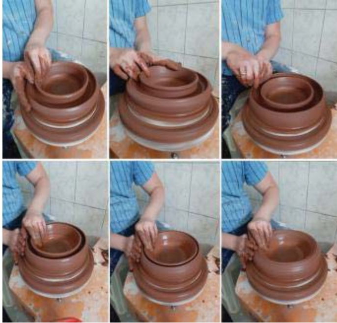
Resim 3.43. Halka(simit) formu yapım aşamaları - Fotoğraf: Aybüke Yıldırım-2019
