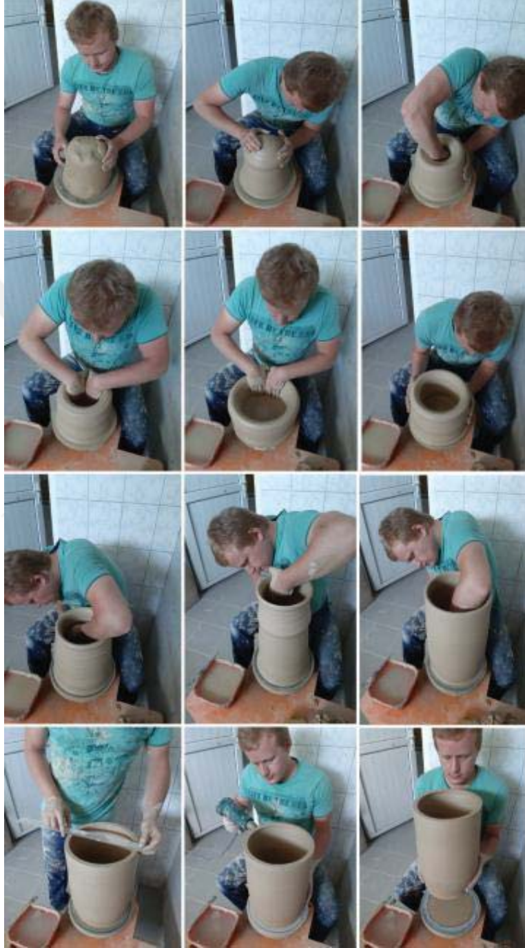
Resim 3.58. Büyük formların yapım aşamaları, parça ekleme usulü, orta parçanın yapımı Fotoğraf: Aybüke Yıldırım-2019
