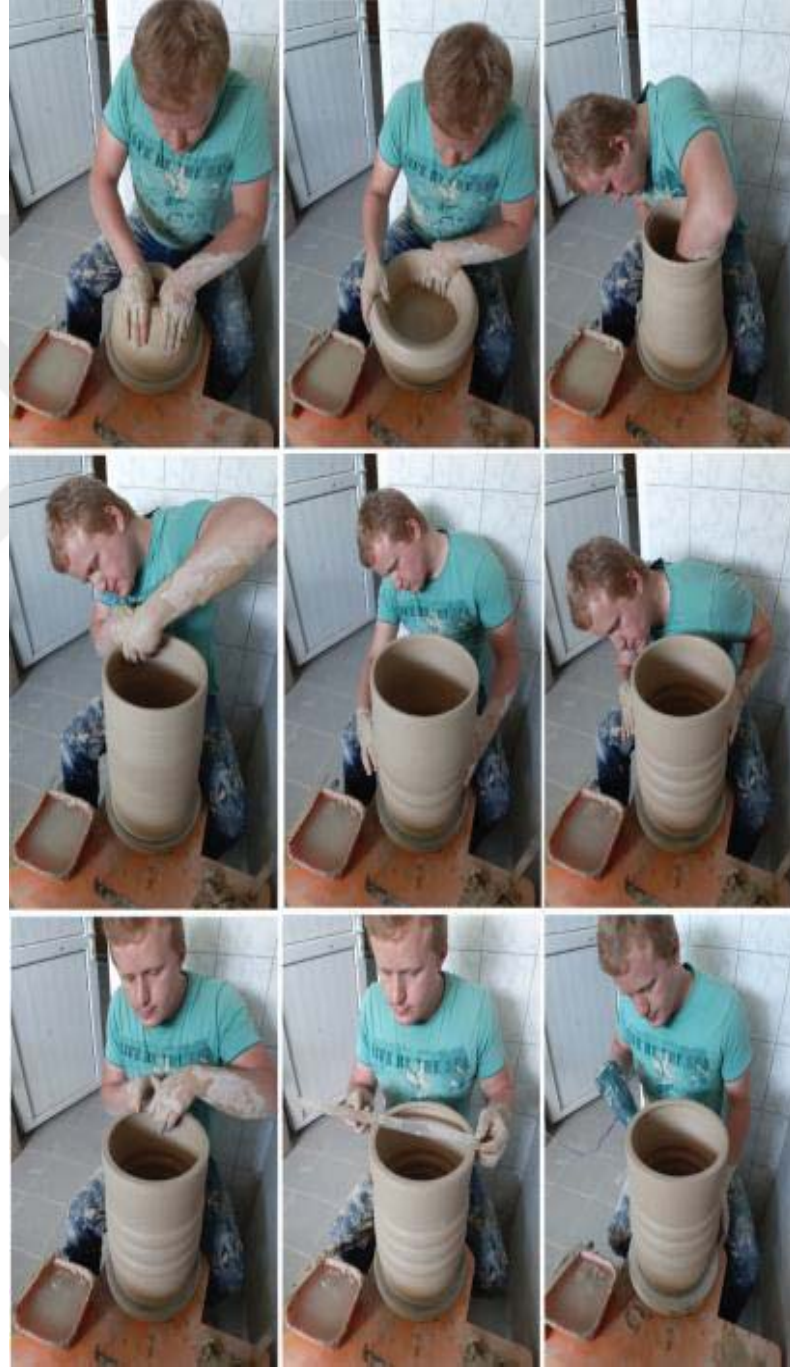
Resim 3.59. Büyük formların yapım aşamaları, parça ekleme usulü, alt parçanın yapımı Fotoğraf: Aybüke Yıldırım-2019
