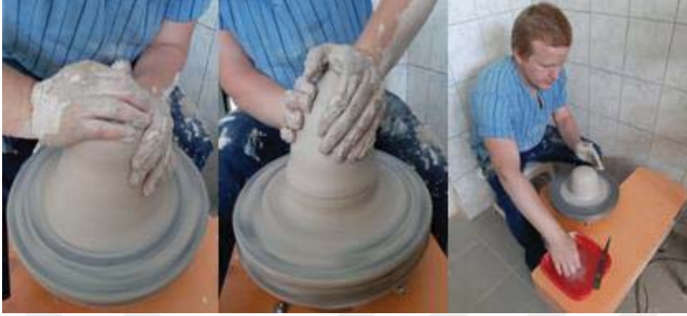
Resim 3.7. Çamuru merkeze alma, ellerin saat iki-sekiz ve dört-on konumu, tek eli ıslatma – Fotoğraf: Aybüke Yıldırım-2019
