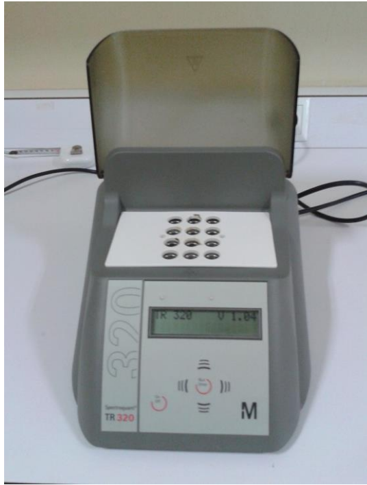
Şekil 4.4. KOİ tayininde kullanılan dijital termal reaktör.
