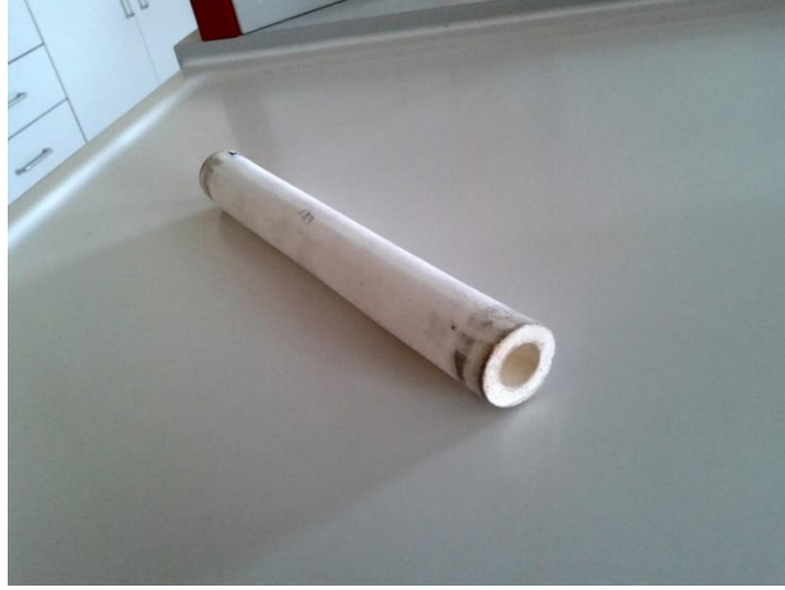
Şekil 4.1. Tübüler seramik ( \alpha -Al 2 O 3 ) membran.
