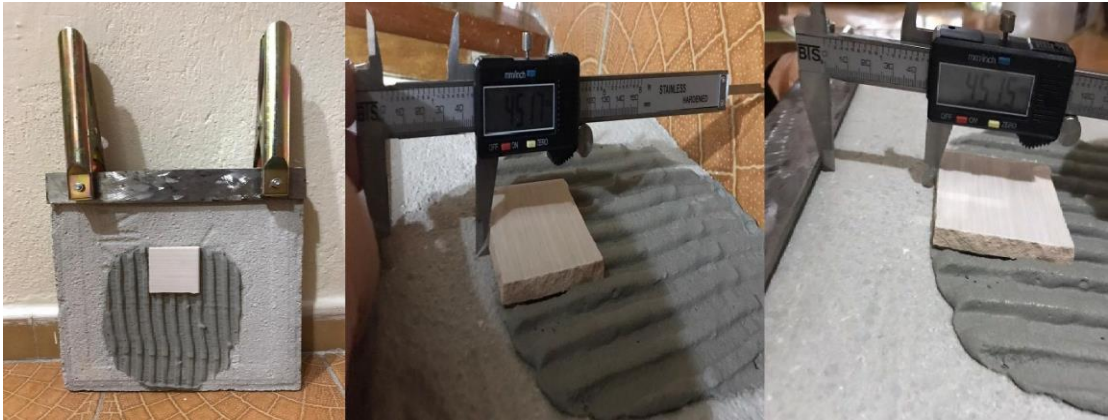
Resim 3.2 Bileşen 1 için hazırlanan numunedeki kayma miktarı.
