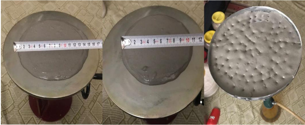
Resim 4.9 Bileşen 2 için su tutma kapasitesi.
