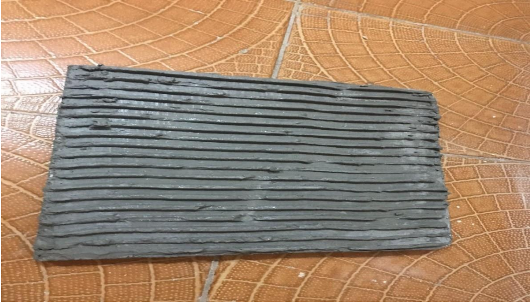
Resim 3.1 Bileşen 1 için hazırlanan numunedeki işlenebilirlik.
