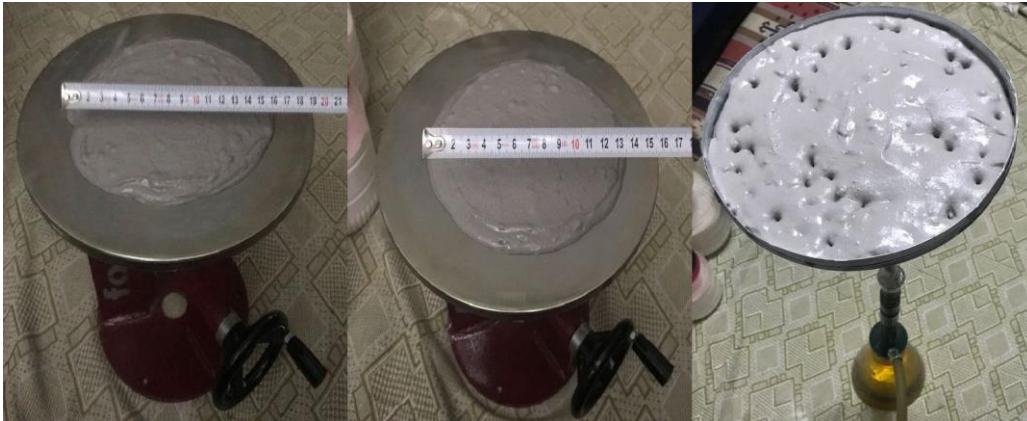
Resim 4.10 Bileşen 3 için su tutma kapasitesi.
