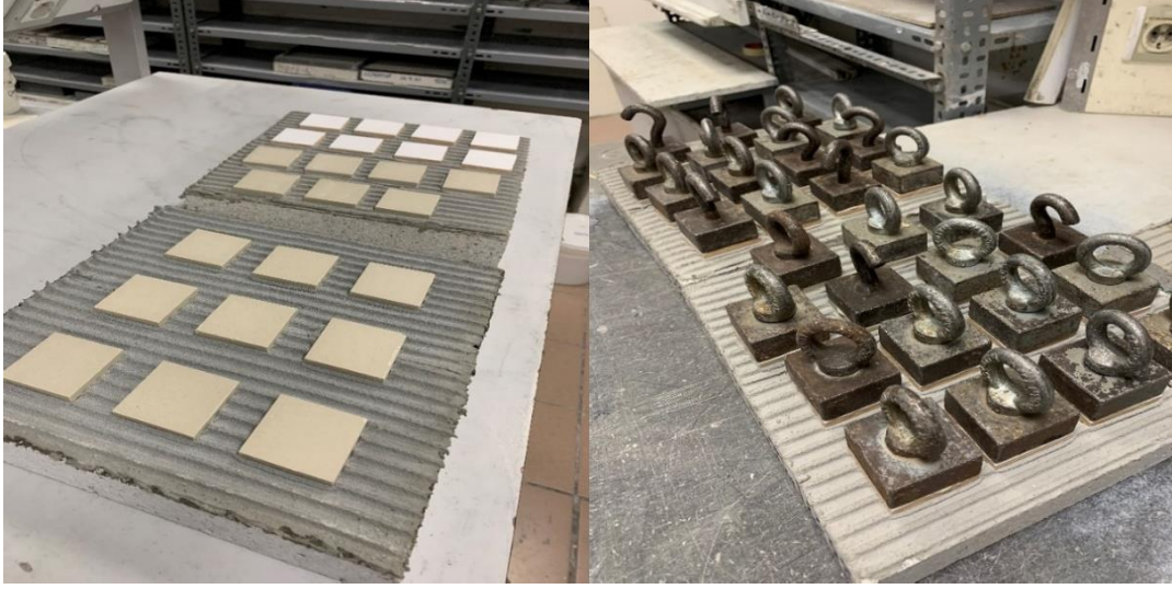
Resim 4.12 K rleme boyunca bařlangıç yapıřma mukavemeti, 30.dk a ık bekletme s resi sonrası yapıřma mukavemeti.
