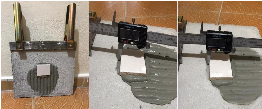
Resim 4.4 Bileşen 2 için hazırlanan numunedeki kayma miktarı.
