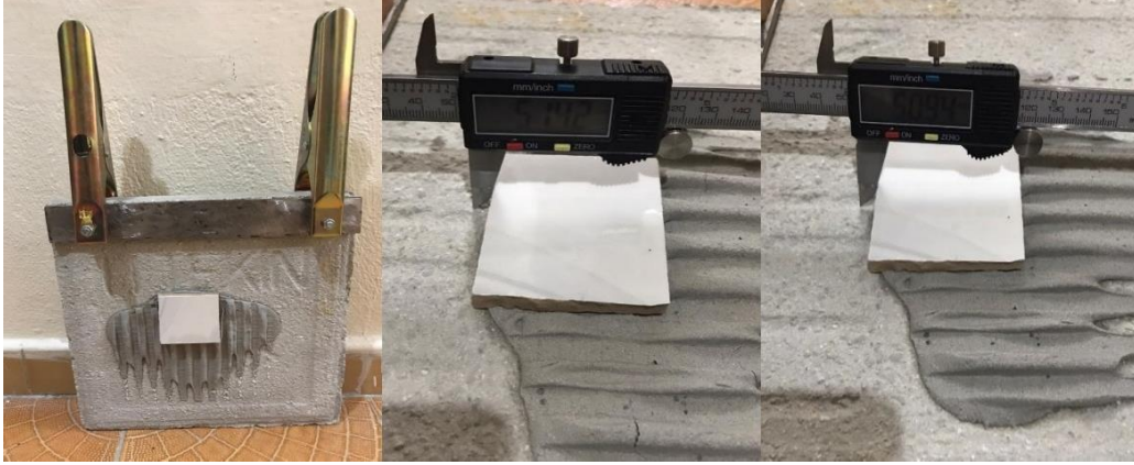
Resim 4.5 Bileşen 3 için hazırlanan numunedeki kayma miktarı.
