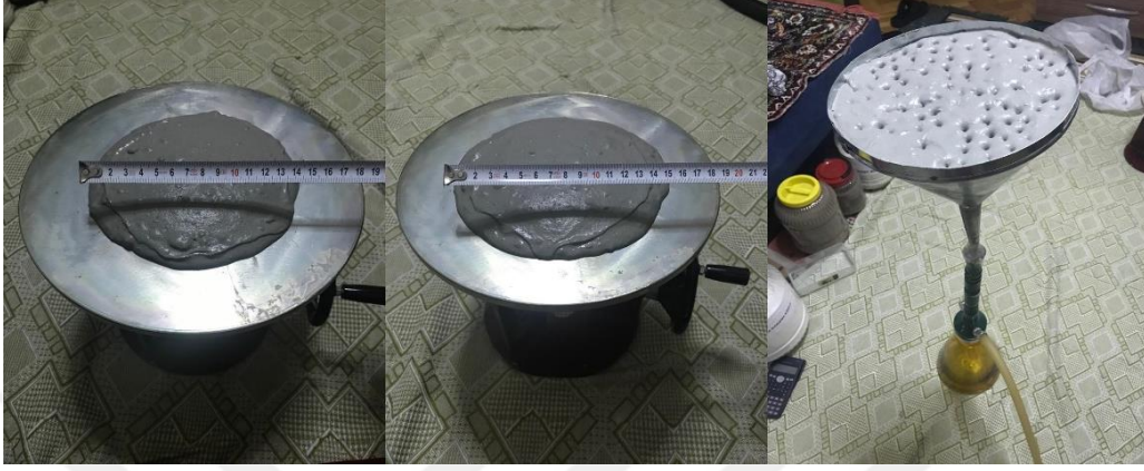
Resim 3.8 Bileşen 1 için hazırlanan numunedeki su tutma kapasitesi.
