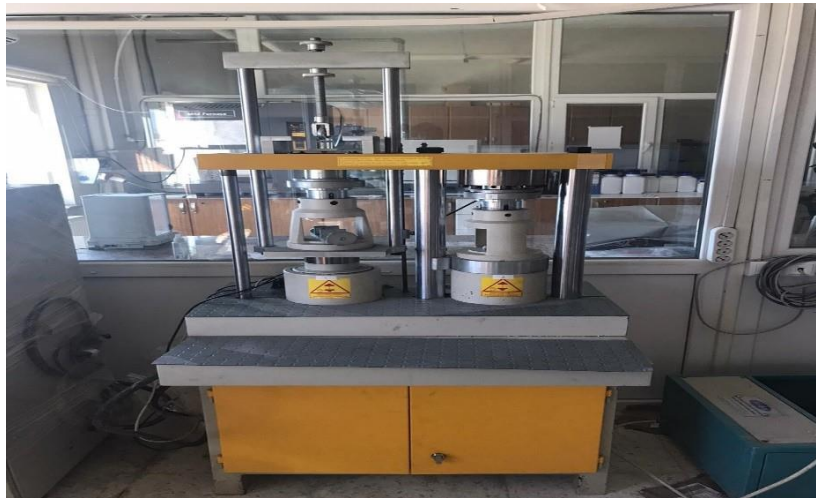
Resim 3.6 Açık zaman tayini çekme mukavemeti ölçüm cihazı.
