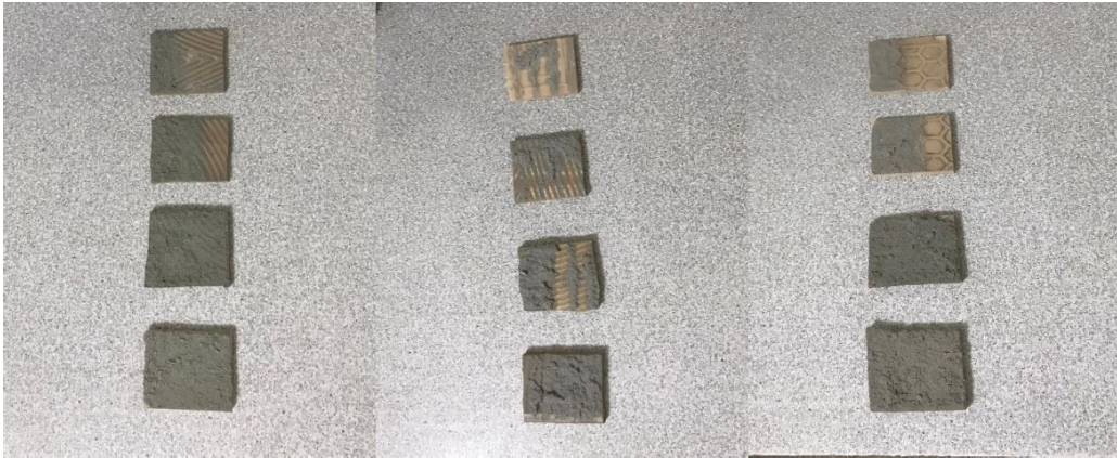
Resim 4.7 Bileşen 2, 3 ve 4 için hazırlanan numunelerdeki kabuklaşma süreleri.
