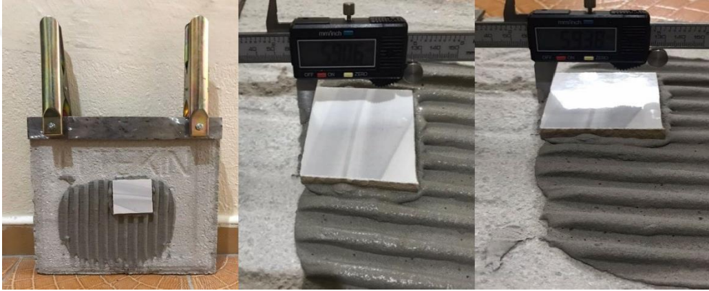
Resim 4.6 Bileşen 4 için hazırlanan numunedeki kayma miktarı.
