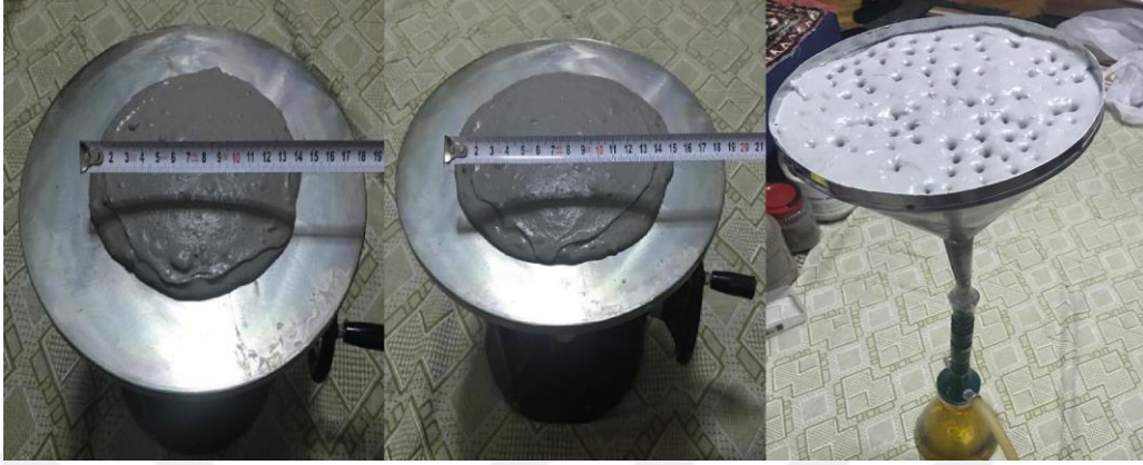
Resim 4.8 Bileşen 1 için su tutma kapasitesi.
