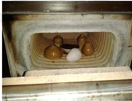
Şekil 65- Muffel tipi deneme fırını, iç ölçüler 21x 30x12 cm
