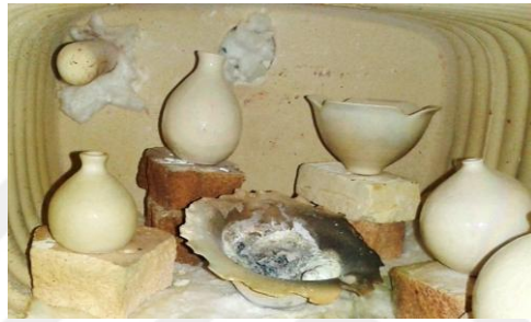
Şekil 72- Deneme fırınının içine yerleştirilmiş buharlaşan bileşikler ve formlar, pişirim sonrasında, 2014
