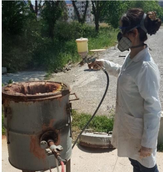
Şekil 61- Püskürtme yöntemi uygulama aşaması. Fotoğraf Sedat Tosun
