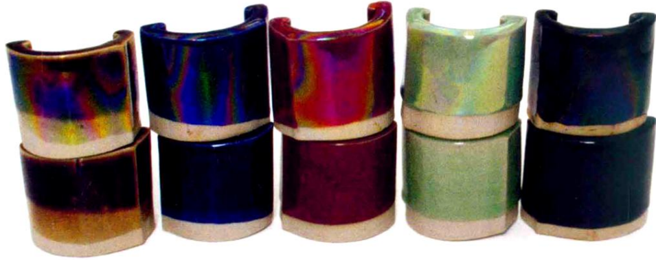
Şekil 37- Sırlı pekişmiş bünye, üst sıradaki denemeler üzerine kalay klorür ile 650°C’da buharlaşma yapılmıştır (Daly,2014:129)
