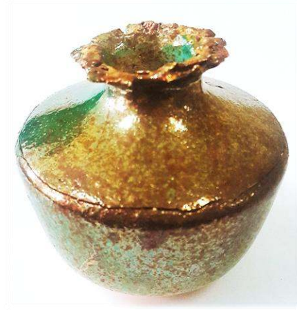
Şekil 78- Beyaz vakum çamuru üzerinde püskürtme lüsteri etkisi ve termal şoktan dolayı meydana gelen çatlak, Y: 9 cm, 2014, fotoğraf: Sedat Tosun
