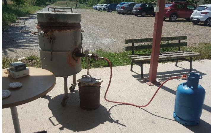
Şekil 66- Pişirimde kullanılan gaz yakıtlı fırın, fotoğraf: Sedat Tosun
