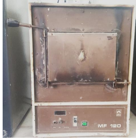
Şekil 64- DEÜ GSF Seramik Bölümü kimya laboratuvarında muffle tipi deneme fırını, iç ölçüler 21x 30x12 cm
