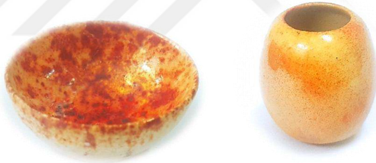
Şekil 79- Su spreyi (solda) ve pistole ile (sağda) minyatür formlar üzerinde oluşan püskürtme lüsteri etkileri, 2014, fotoğraf: Sedat Tosun
