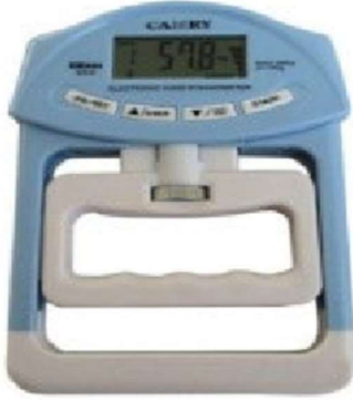
Şekil 3.5.B El kavrama kuvveti ölçüm dinamometresi
