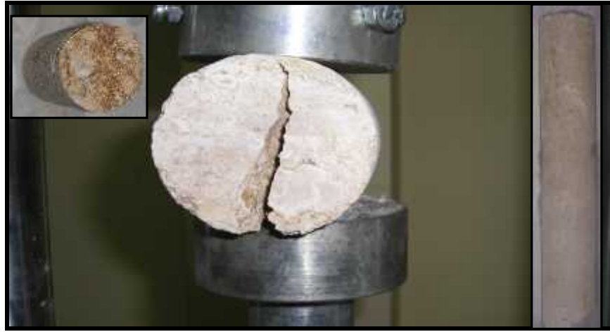
Şekil 5.2. Kireçtaşının dolaylı çekme dayanımı deneyinden bir görünüm
