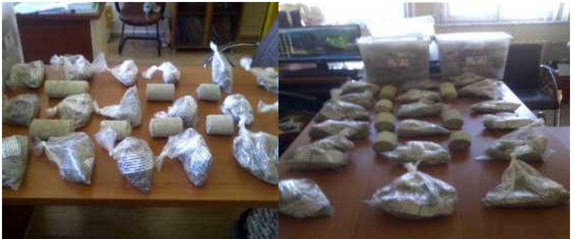
Şekil 5.7. Araştırma sondajlarının açımı sırasında değişik lokasyon ve derinliklerden alınan örselenmemiş ve örselenmiş zemin örnekleri
