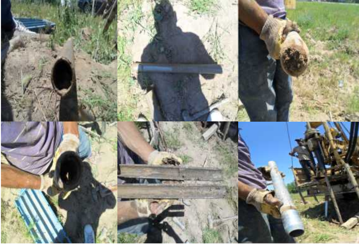
Şekil 5.3. Geçirimlilik deneyinde kullanılan karotiyerlerden görünüm
