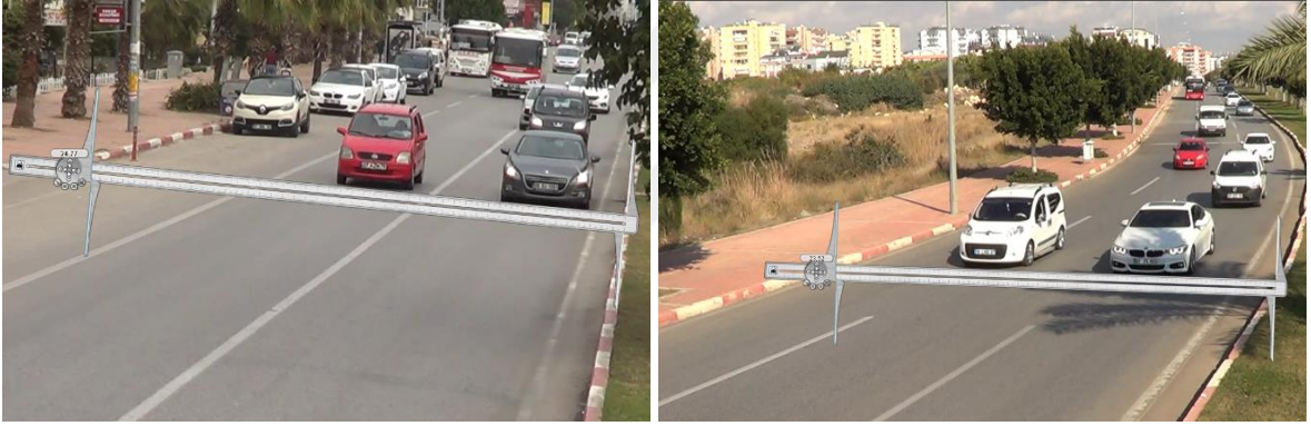
Şekil 2.19. Araçların yol yüzeyindeki yanıl konumlarının ekran ölçeklendirilmesi yöntemiyle belirlenmesi
