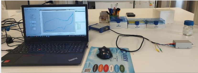
Şekil 3. 10 Gamry Interface 1010E Potentiostat/Galvanostat/ZRA ile elektrokimyasal ölçüm sistemi
