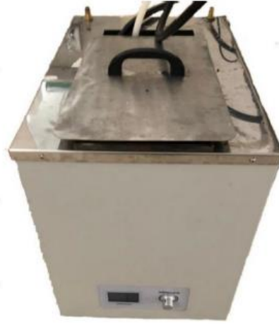
Şekil 3.4. Soğutma ve ısıtma sağlayan su banyosu
