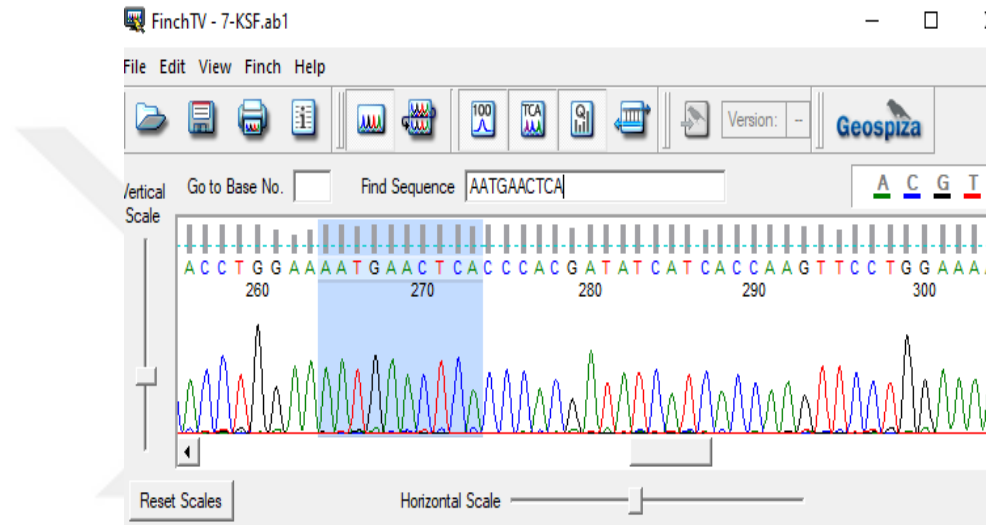
Şekil 6. Dizi analizi sonuçlarının Finch TV'de analizi
