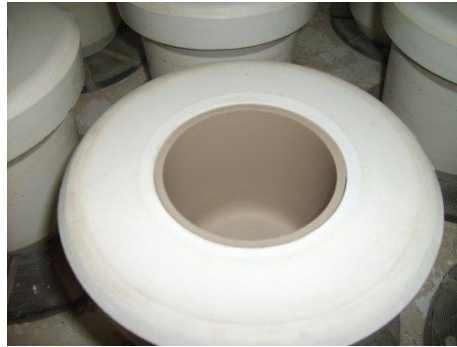
Şekil 3.5. Torna işlemi sonrası kalıptan çıkarılmayı bekleyen ürün (Kılıçarslan Seramik).
