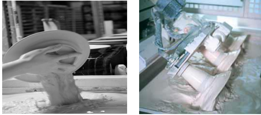
Şekil 3.20. Daldırmalı sırlama işlemi (a) manuel sırlama (b) otomatik sırlama (Lippert sırlama broşürü)
