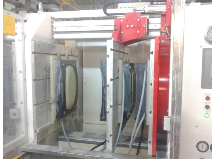
Şekil 3.10. Basınçlı döküm makinesi (Porland Porselen A.Ş.).
