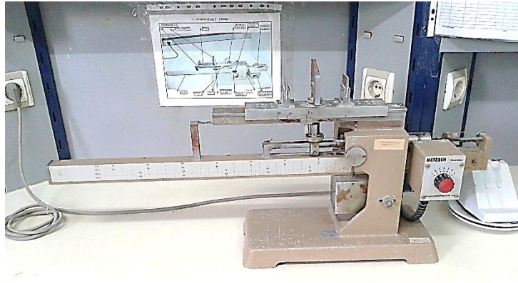
Şekil 6.7. Üç nokta eğme mukavemet ölçüm cihazı.
