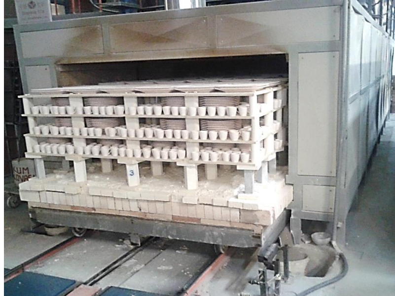
Şekil 3.19. Endüstriyel ölçekli sırsız gövde pişirimi yapılan tünel fırın (Porland Porselen A.Ş.).
