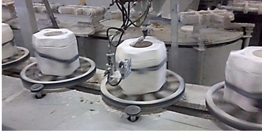
Şekil 3.8. Otomatik hassas döküm işlemi (Porland Porselen A.Ş.).
