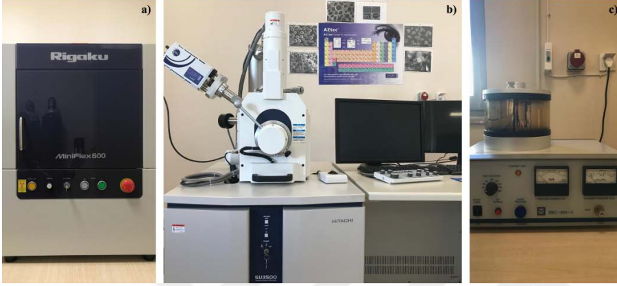
Şekil 2.7. (a) XRD cihazı, (b) SEM cihazı ve (c) kaplama cihazı.
