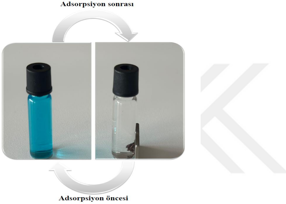
Resim 3.6. İdeal adsorpsiyon parametrelerinde seryum temelli manyetik partiküller ile malahit yeşili boya çözeltisinin adsorpsiyon öncesi ve sonrası görünümü
