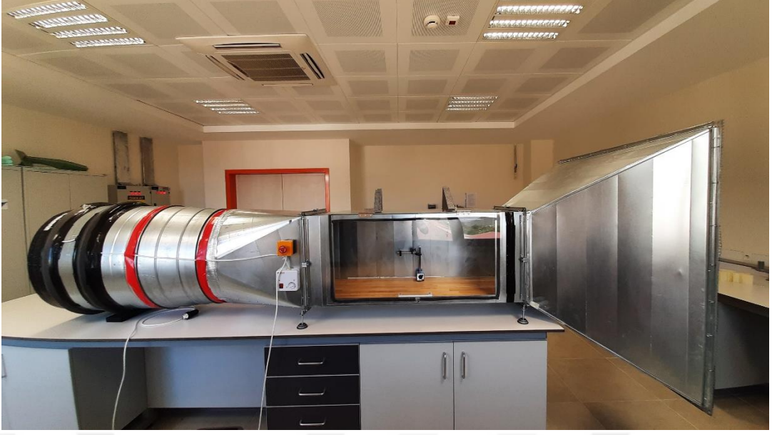
Şekil 3.6. İmalatı yapılan rüzgar tüneli
