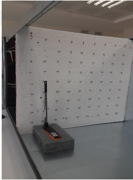
Şekil 5.1. Sıcak tel anemometresinin kılavuzlanması
