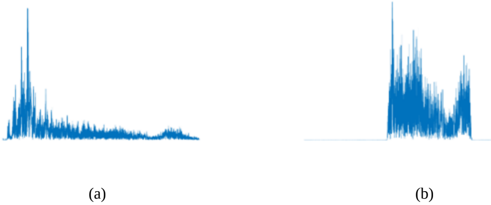
Şekil 37. Sesin frekans uzayı (a) Band geçiren süzgeç işlemi uygulanmamış (b) Band geçiren süzgeç işlemi uygulanmış
