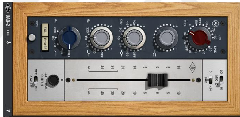
Görsel 138. UAD Neve 1073 DPA Preamp gitar ve vokal parametreleri (Yazılım)
