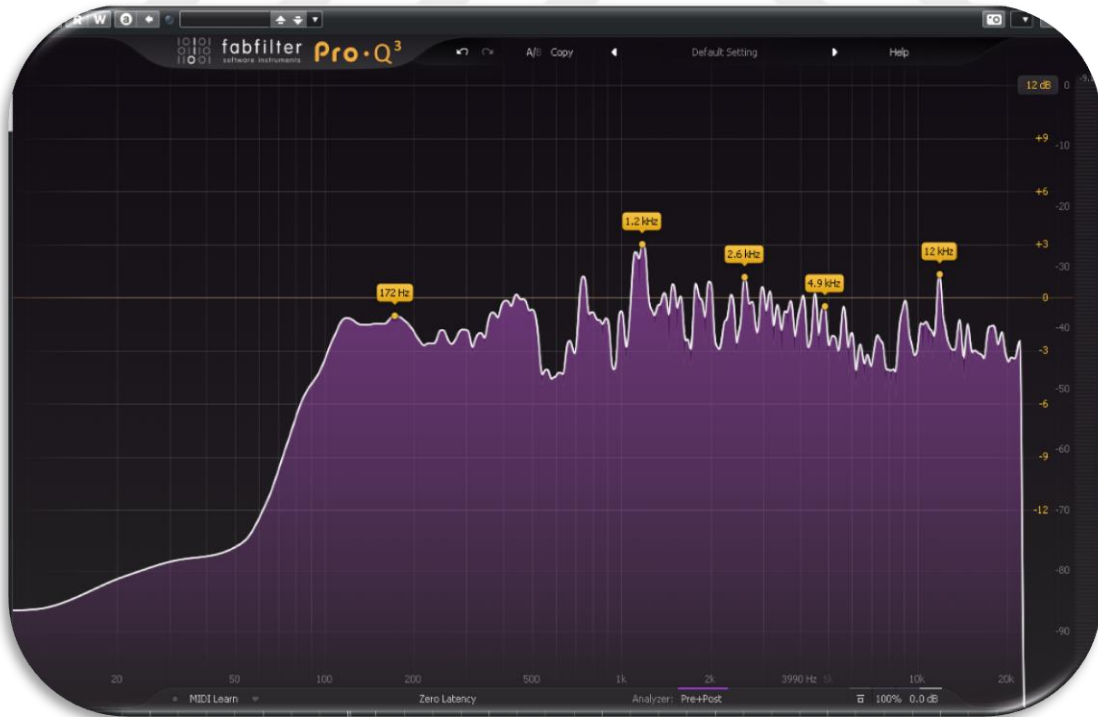
Görsel 76. Gitarın spektrum analiz görüntüsü (Yazılım)
