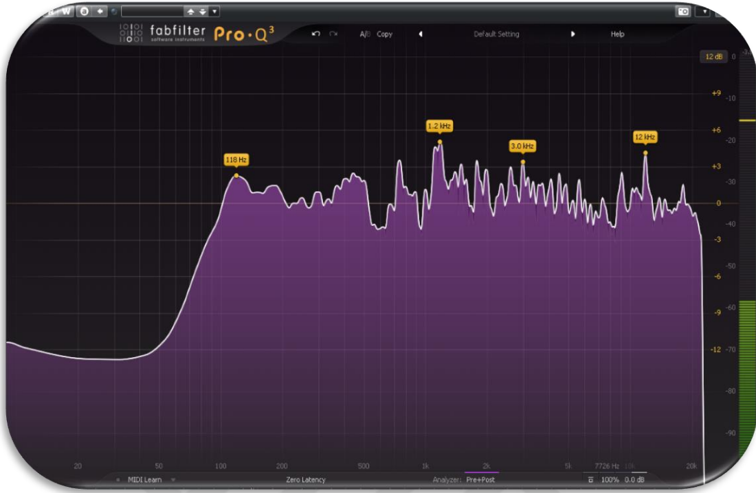
Görsel 191. Gitarın spektrum analiz görüntüsü (Analog)
