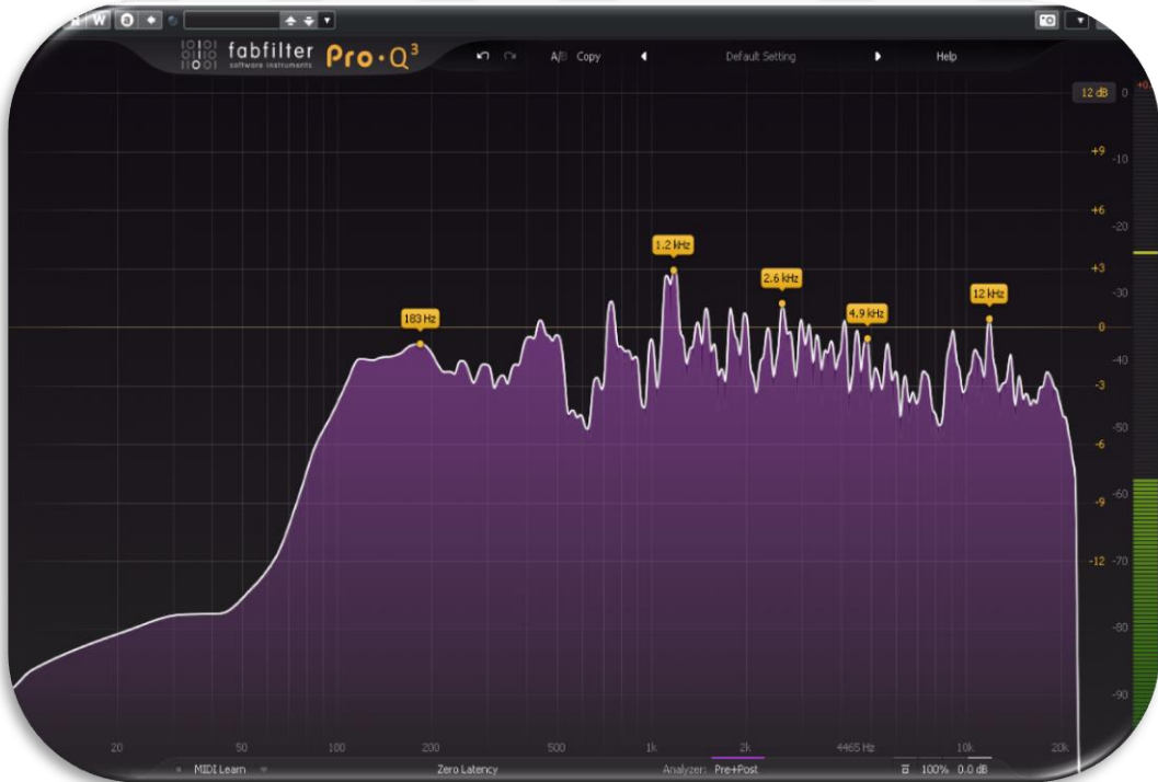
Görsel 108. Gitarın spektrum analiz görüntüsü (Yazılım)
