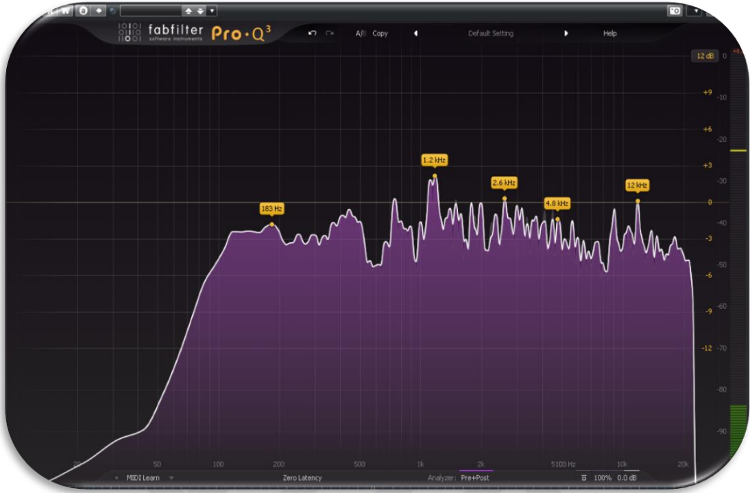
Görsel 91. Gitarın spektrum analiz görüntüsü (Analog)
