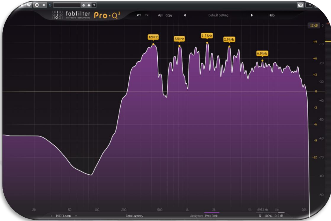
Görsel 61. Vokalin spektrum analiz görüntüsü (Analog)
