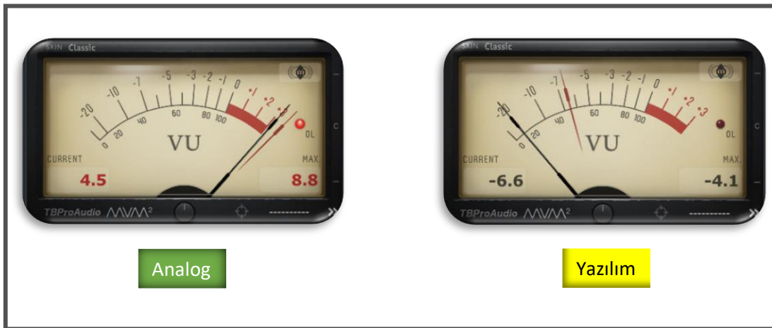
Görsel 174. Vokalin mvMeter-2 maksimum peak görüntüsü
