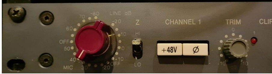
Görsel 137. AMS Neve 1073 DPA Preamp gitar ve vokal parametreleri (Analog)
