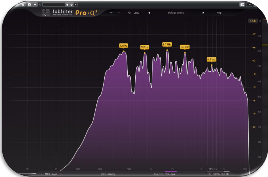
Görsel 62. Vokalin spektrum analiz görüntüsü (Yazılım)
