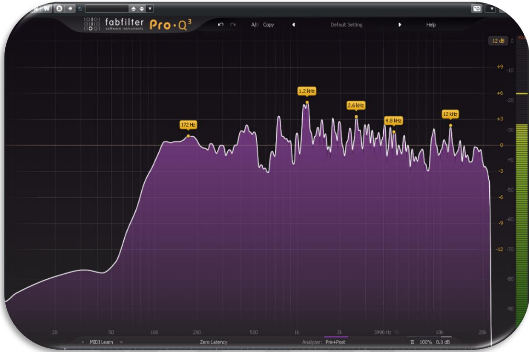
Görsel 107. Gitarın spektrum analiz görüntüsü (Analog)
