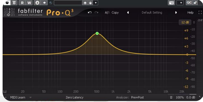
Görsel 33. Parametrik Ekolayzer Üzerinde Q Eğrisi (Q=1150)
