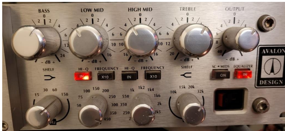
Görsel 118. Avalon Design VT737 EQ parametreleri (Gitar)
