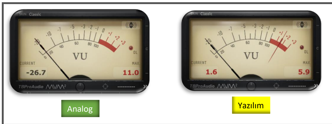
Görsel 106. Vokalin mvMeter-2 maksimum peak görüntüsü
