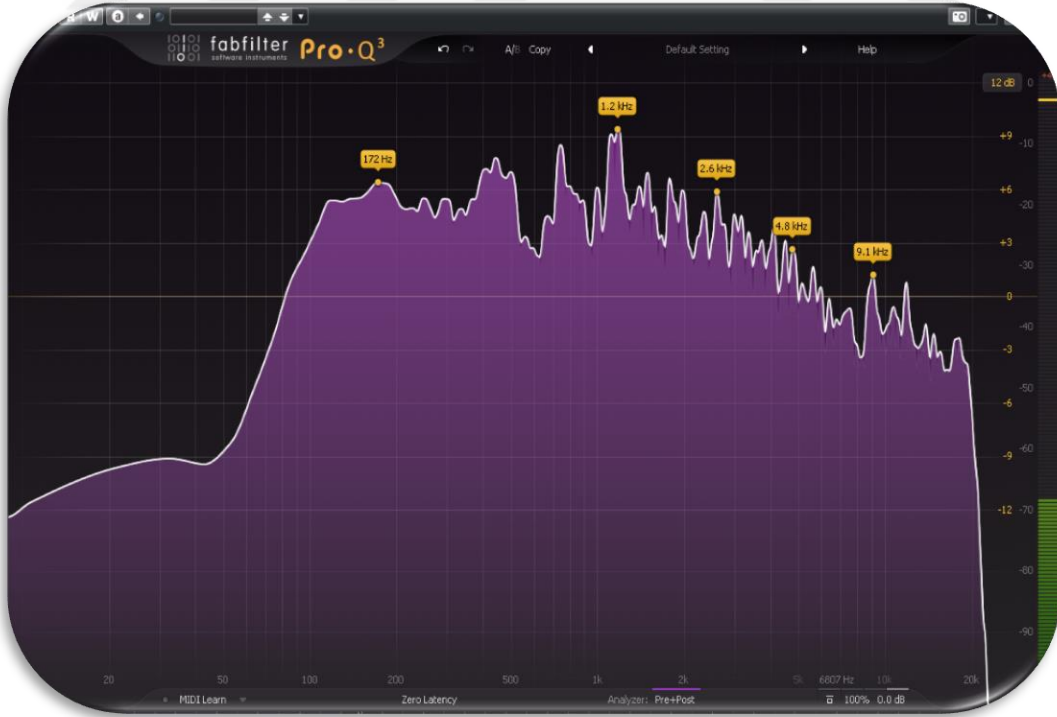
Görsel 144. Gitarın spektrum analiz görüntüsü (Yazılım)
