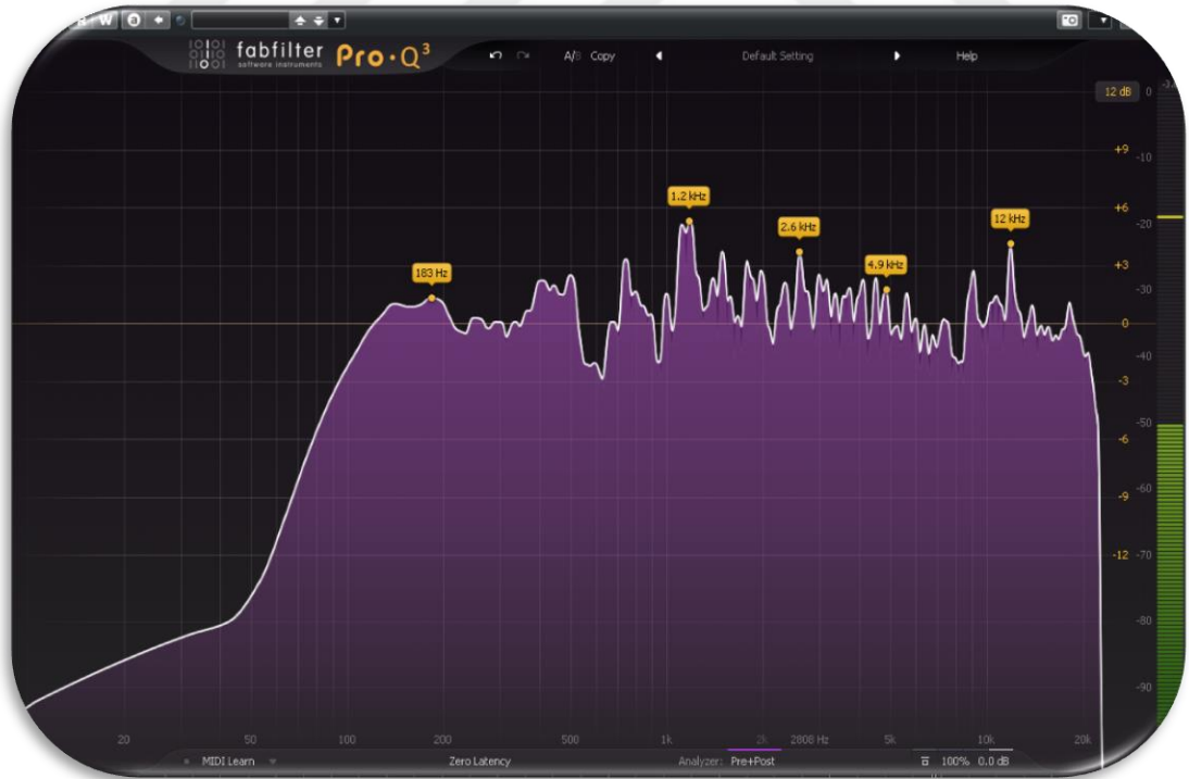
Görsel 128. Gitarın spektrum analiz görüntüsü (Yazılım)
