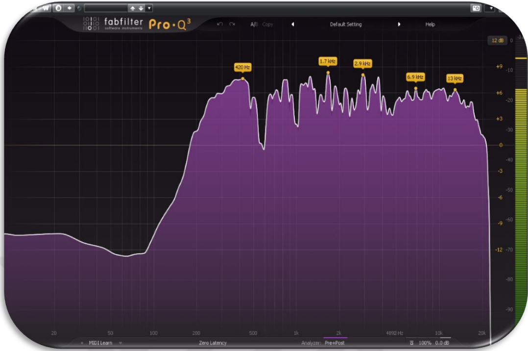
Görsel 77. Vokalin spektrum analiz görüntüsü (Analog)
