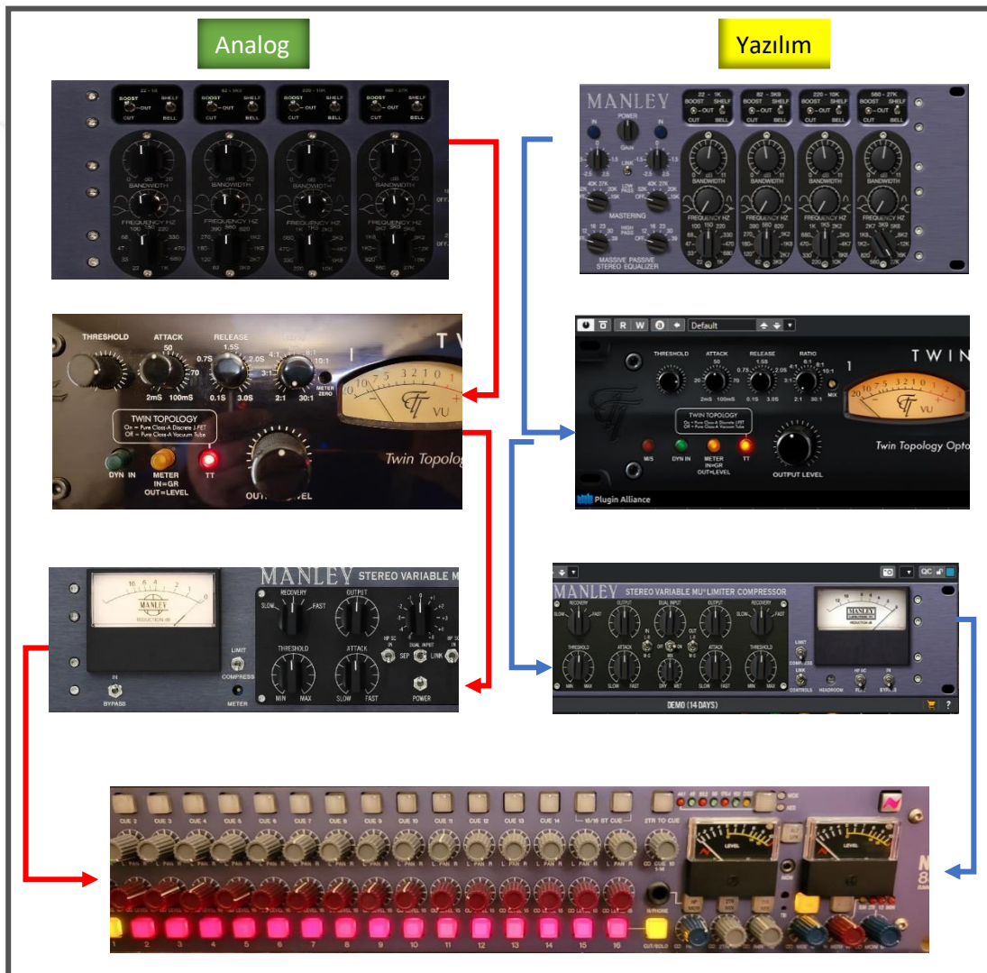
Görsel 201. Analog ve yazılımlardan oluşan gitar ve vokal miks şeması
