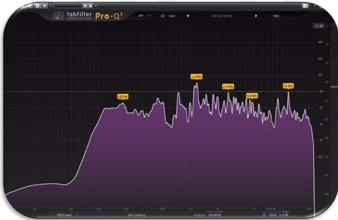
Görsel 192. Gitarın spektrum analiz görüntüsü (Yazılım)
