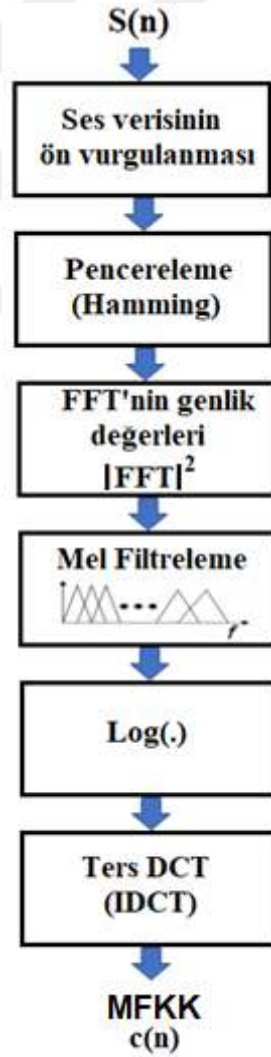
Şekil 2.5. MFKK katsayılarının elde edilme aşamaları
