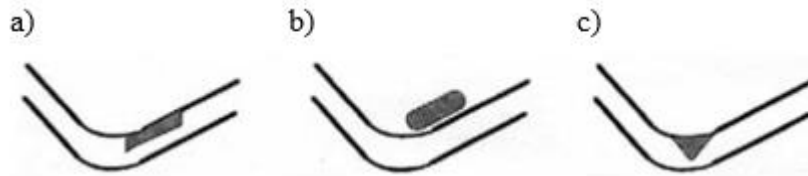
Şekil 2.4: a) Serbest yüzey aşınması b) Krater aşınması c) Burun aşınması (Özdemir ve Erten, 2003).
