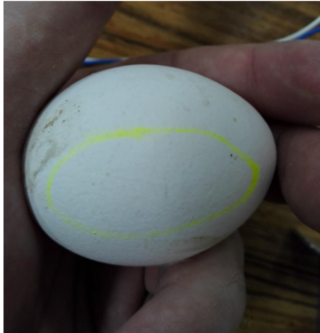
Resim 4.2 Mikro çatlak bulunan yumurtanın baskı uygulanmamış durumdaki görseli.
