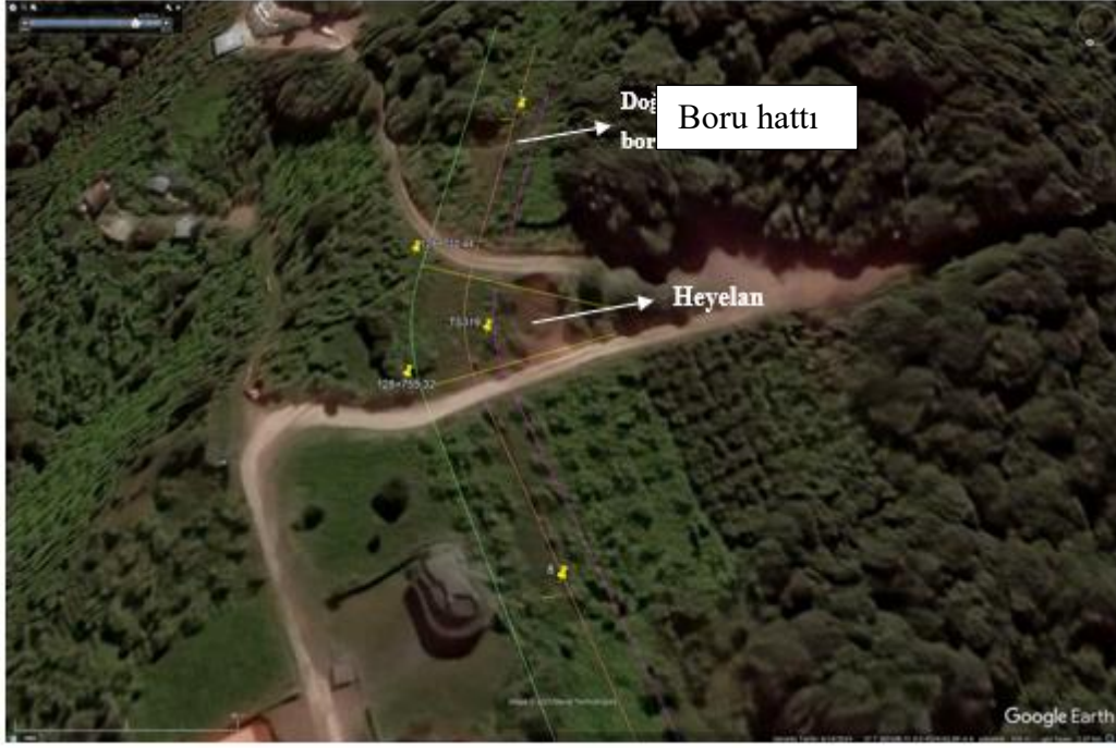
Şekil 37. 2014 yılı itibariyle boru hattının hemen batısında meydana gelen ve üst kottaki yolu etkileyen heyelanın Google Earth uydu görüntüsü (URL-2, 2024)
