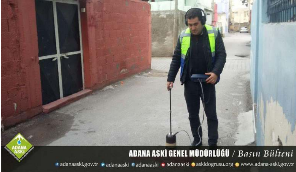
Şekil 3.16. Fiziki Su Kayıplarının Ultrasonik Dinleme Aygıtı ile Tespiti (Adana ASKİ, 2018)
