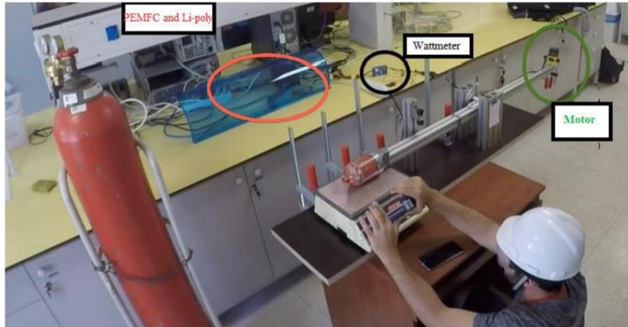
Şekil 2.20. Hibrit sistemin itki testleri (Özbek vd., 2021)
