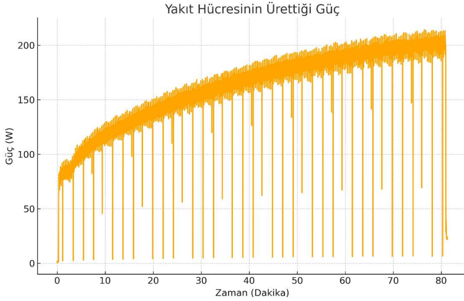
Şekil 4.1. Son yük testinde yakıt hücresinin ürettiği güç grafiği
