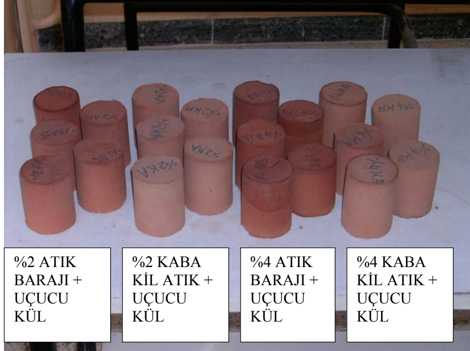
Şekil 5.15 %2 ve %4 atık barajı malzemesi ve kaba kil atık malzemesi kullanılarak yapılan tuğlaların fırında 800 °C’de pişirildikten sonraki durumları
