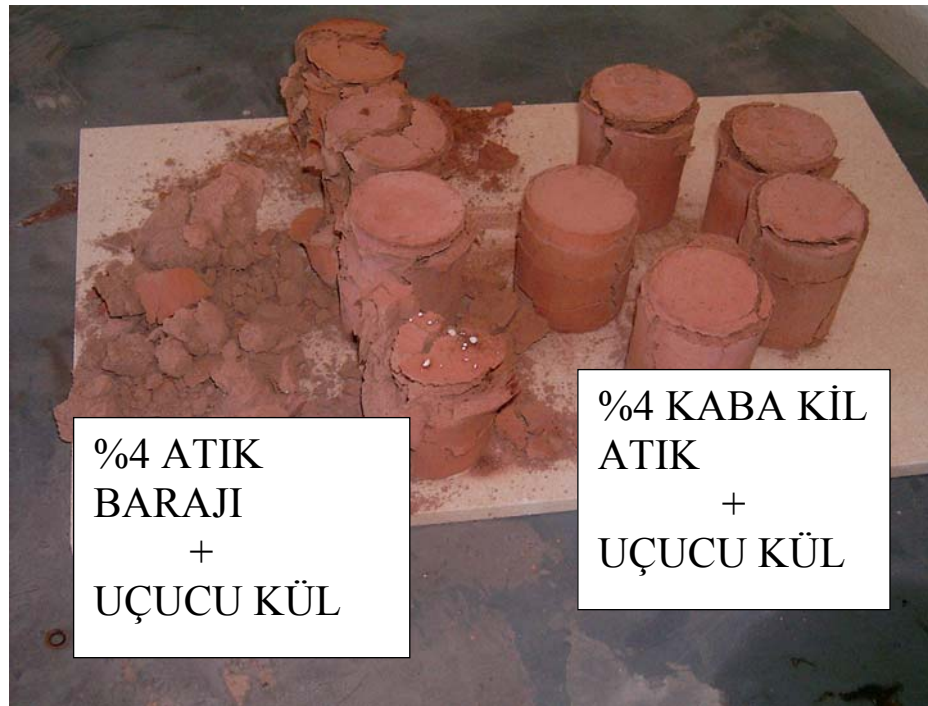
Şekil 5.5 %4 Kaba kil atık ve %4 atık barajı malzemesi ile yapılan tuğlaların fırında 1 saat boyunca 900 °C'de pişirildikten sonraki durumları
