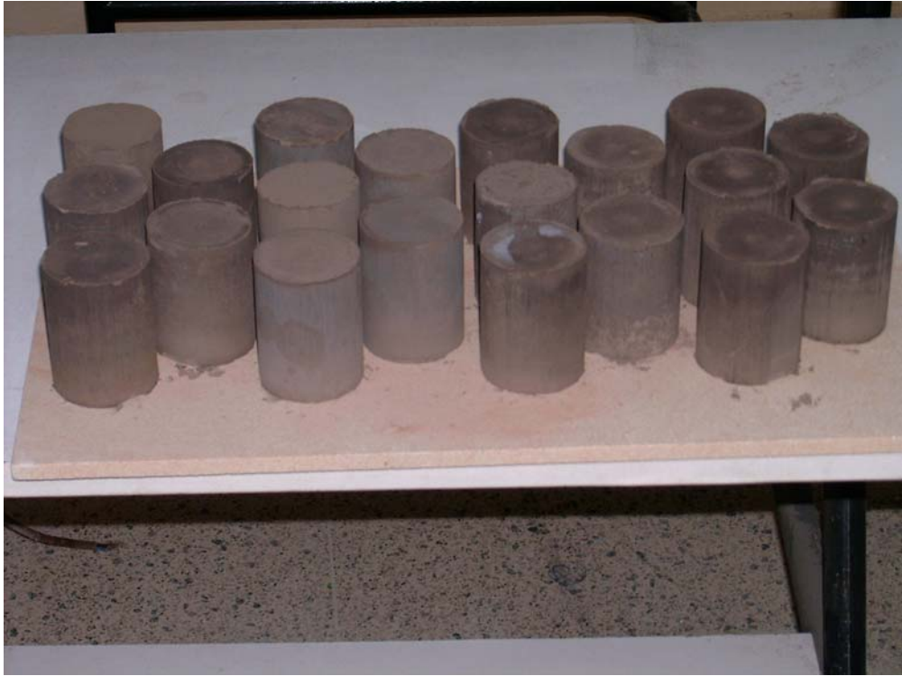
Şekil 5.10 %2 ve %4 oranlarında kaba kil atık malzemesi ile yapılan tuğlaları Fırına konmadan önceki durumları
