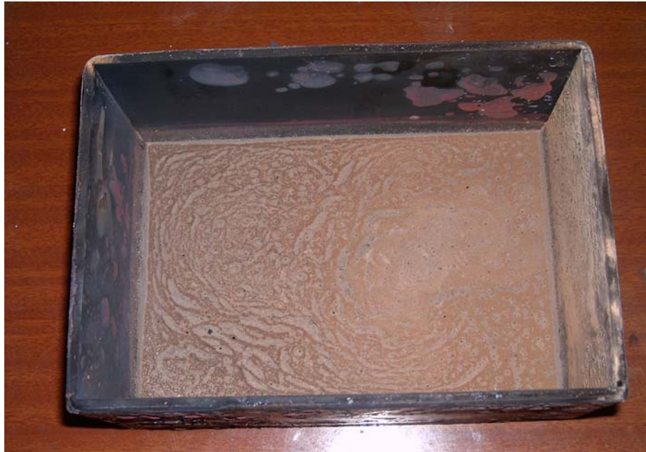
Şekil 5.7 Atık barajı malzemesinin fırında 700 °C'de 1,5 saat boyunca kalsine edildikten sonraki durumu
