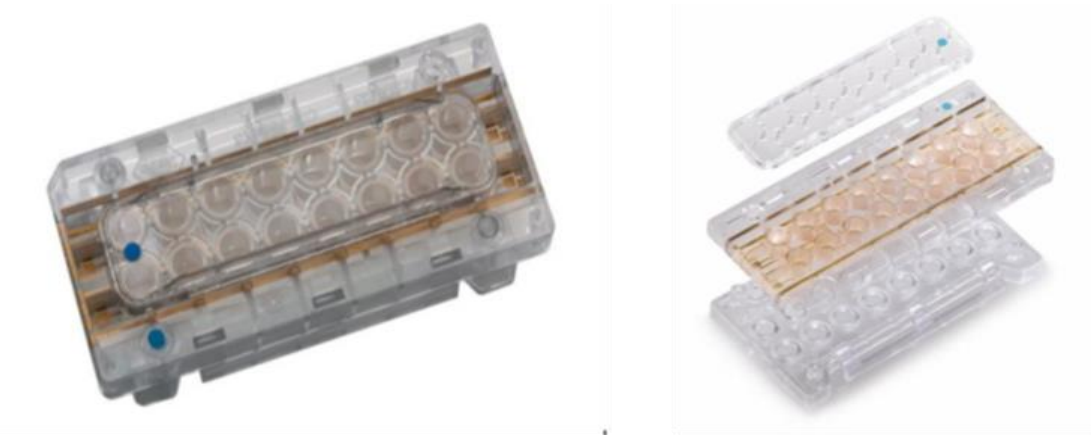
Şekil 3.3. İnvazyon ve migrasyon çalışmalarında kullanılan 16 kuyucuklu CIM plaka
