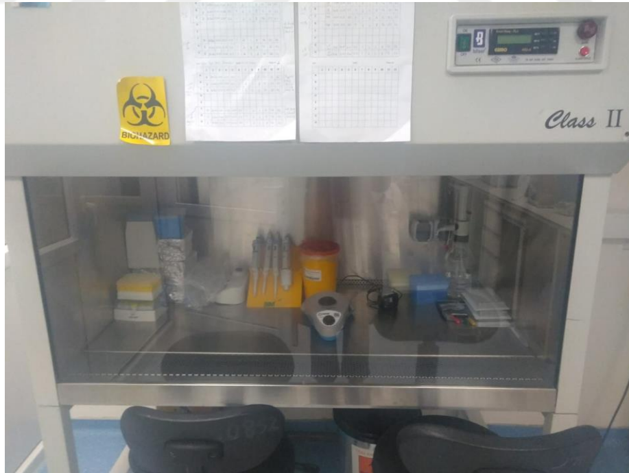
Şekil 3.6. Çalışmada kullanılan biyogüvenlik kabini ClassII A2 (Bilser BLF 2000)
