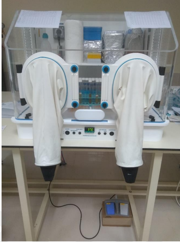
Şekil 3.5. Çalışmada kullanılan anaerobik kabin (Whitley DG250, Don Whitley, West Yorkshire, UK)
