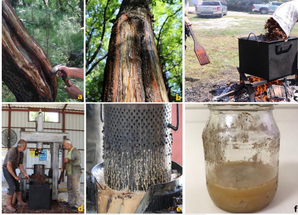
Şekil 2.8. Sığla yağının üretim aşamaları. Damar açma işlemi (a), patolojik balsam kanallarından sızan sığla balsamı (b), torbalara doldurulup sıkılan sıyrıntıların kaynatılması (c), presleme işlemi (d, e) ve piyasaya arz edilebilecek hale gelen sığla yağı (f) (Anonim, 2023a; Anonim, 2023b)
