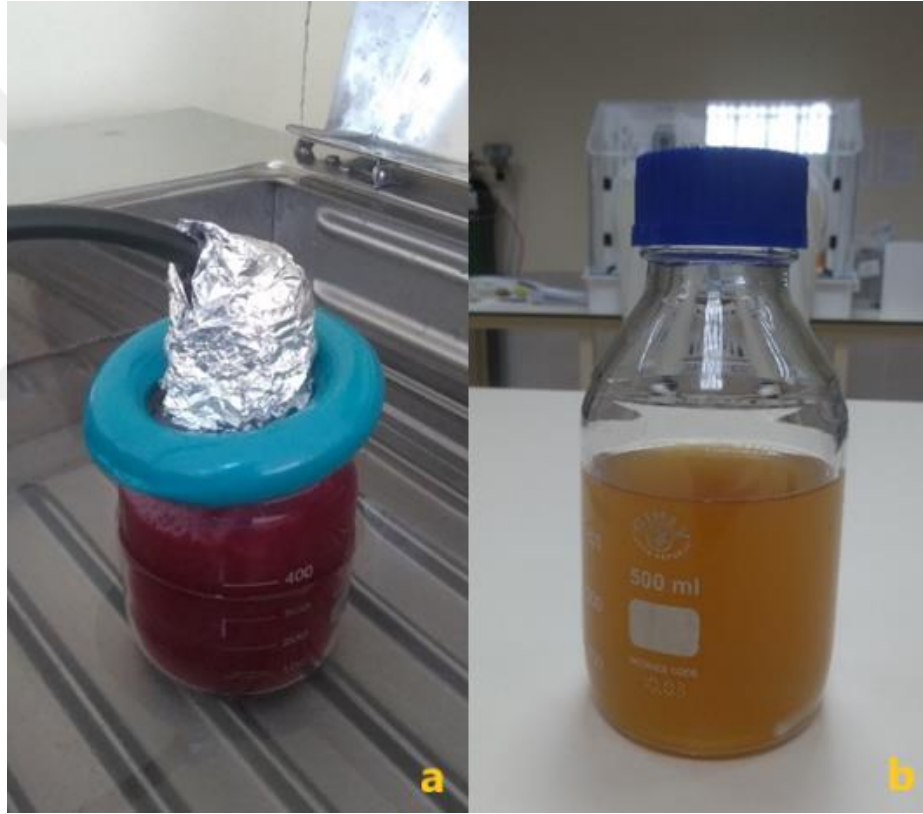
Şekil 3.3. Besiyerinin karbondioksitle doyurulma işleminin başlangıcındaki (a) ve işlem tamamlandıktan sonraki (b) görünümü
