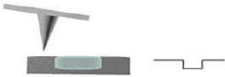
Şekil 3.18. AFM' de cantilever bükülmesi[14]
