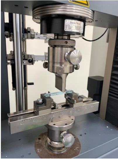
Şekil 5.5. Üç eksenli eğme testinin üretilen deney numunelerine uygulanması
