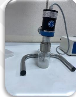
Epoksi reçineye Si 3 N 4 katılması ve ultrasonik karıştırılması
