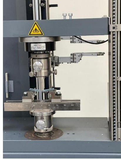
Şekil 5.5. Üç eksenli eğme testinin üretilen deney numunelerine uygulanması
