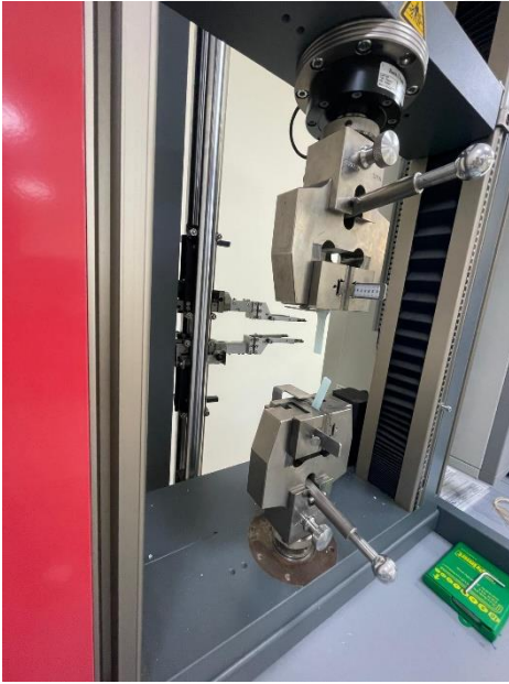
Şekil 5.4. Çekme testinin üretilen deney numunelerine uygulanması
