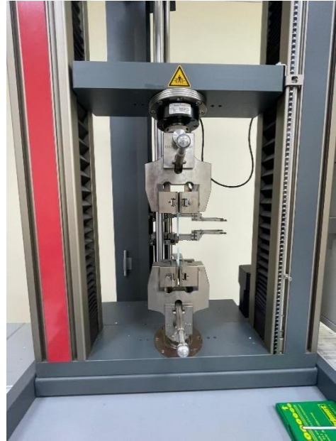
Şekil 5.4. Çekme testinin üretilen deney numunelerine uygulanması
