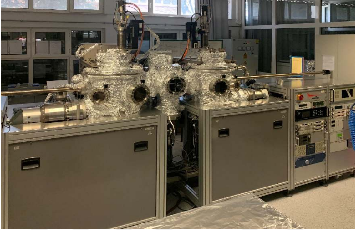
Görsel 2.1. Eskişehir Teknik Üniversitesi Malzeme Bilimi ve Mühendisliği Bölümü İleri Teknoloji İnce Film Laboratuvarında bulunan Magnetron Sıçratma Sistemi
