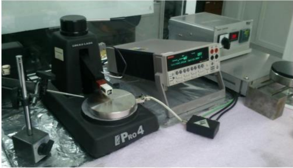
Görsel 2.2. Eskişehir Teknik Üniversitesi İleri Teknoloji İnce Film Laboratuvarı'nda yer alan Dört Nokta Prob ölçüm düzeneği
