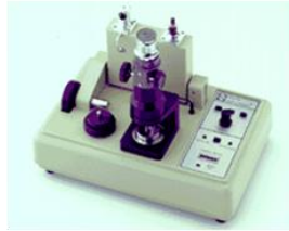
Dimpler cihazı ile numune yüzeyinde çukur oluşturma
