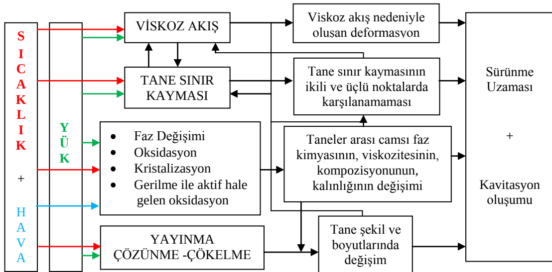
Şekil 6.1. \text{Si}_3\text{N}_4 seramiklerinde sürünme deformasyonuna, özellikle kavitasyon oluşumuna yol açan mekanizmalar ve birbirleri ile etkileşimleri [131]
