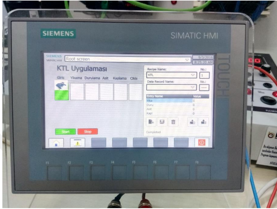
Şekil 11: Siemens marka bir SCADA operatör paneli
