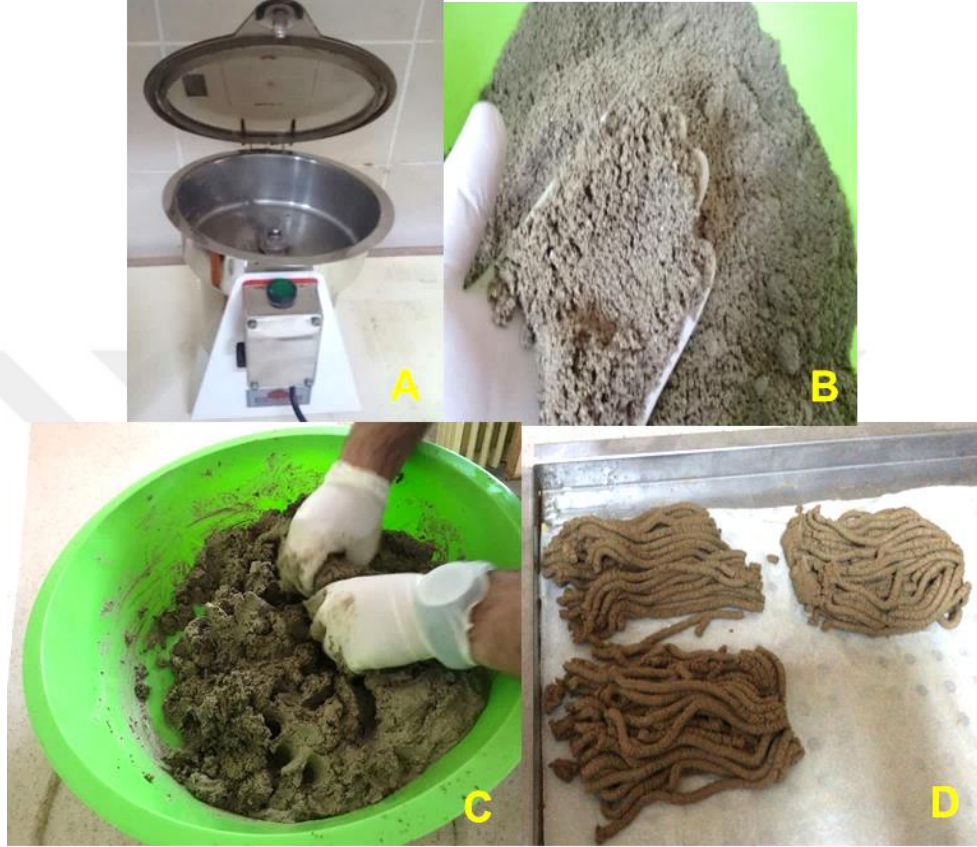
A; Homojenizatör, B; Öğütülmüş, homojenize edilmiş, toz baryum sülfat ( \text{BaSO}_4 ) ilave edilmiş karışım, C; Deneme yeminin yoğurulması, D: \text{BaSO}_4 ilaveli yem
