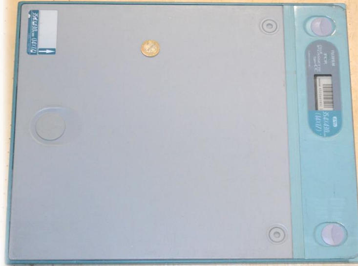
Şekil 11. IP CASSETTE TYPE CC marka Fujifilm kasetleri (35,4x43 cm)
