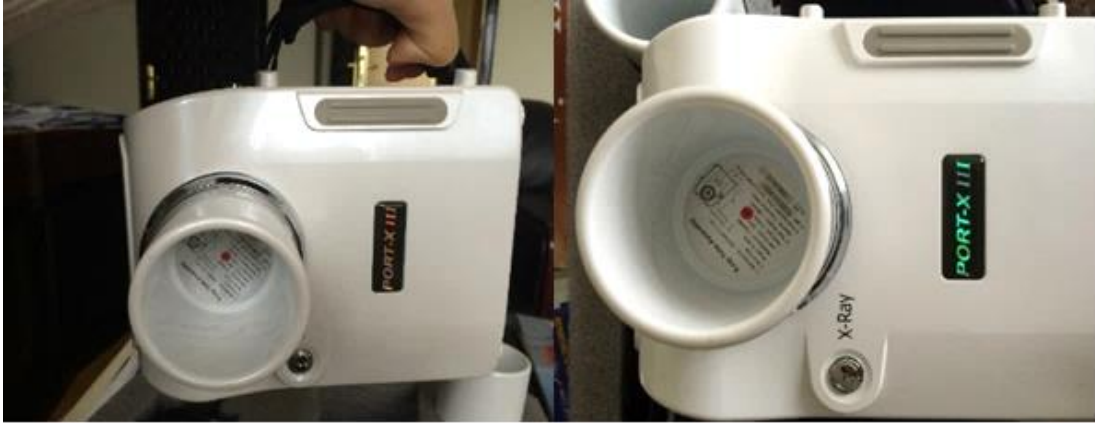
Şekil 9. Mide içeriği görüntülenmesinde kullanılan Toshiba marka Port-X III cihazı.
