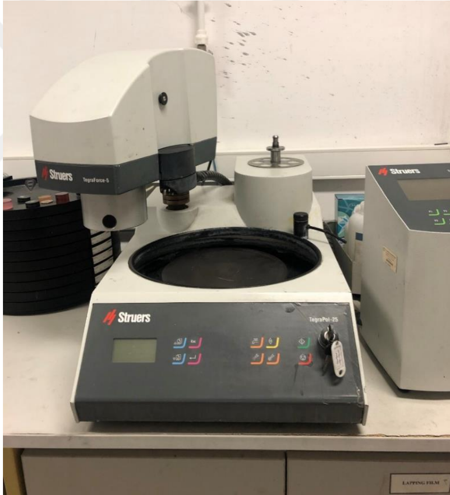
Şekil 3.6. STRUERS TegraPol-25 otomatik parlatma cihazı
