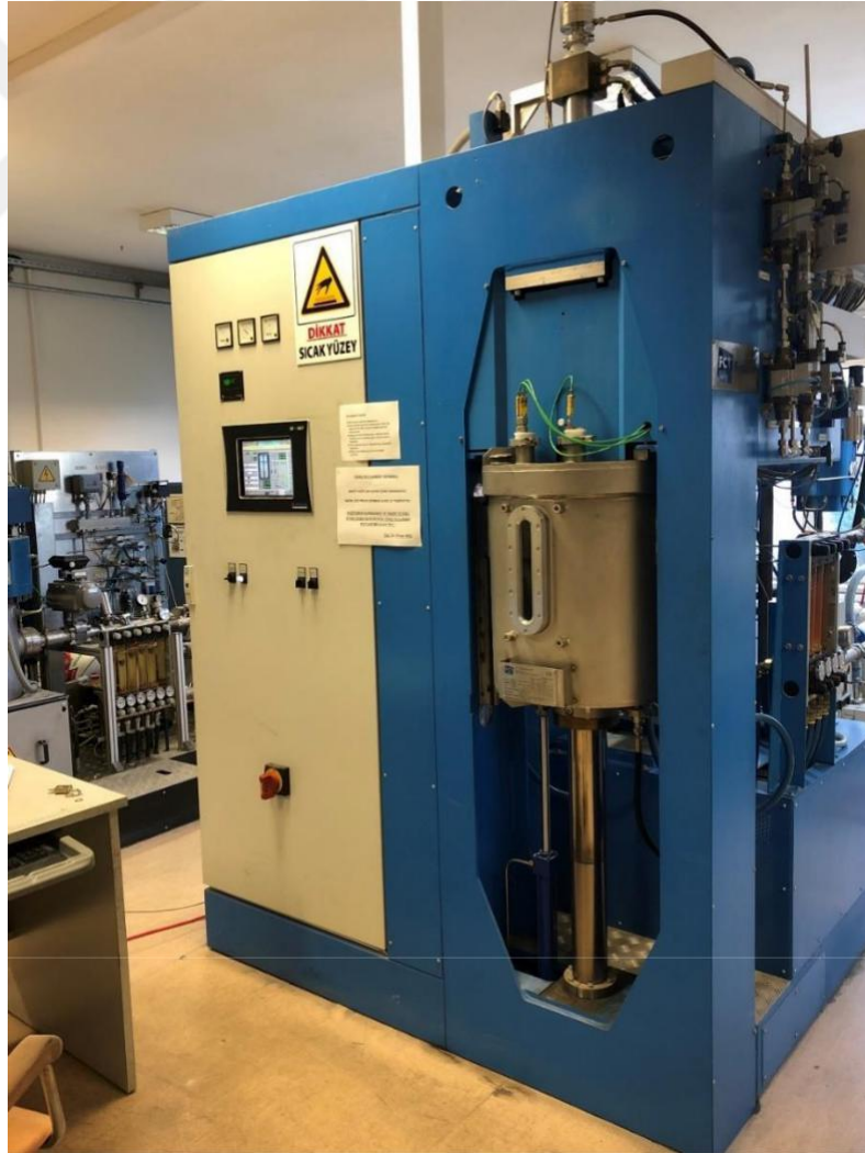
Şekil 3.2. FCT Systeme GmbH HPD 25 Spark Plasma Sinterleme cihazı
