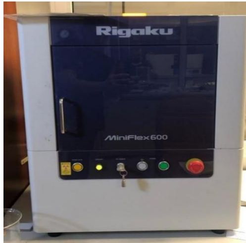
Şekil 3.9. Rigaku Miniflex 600 XRD cihazı
