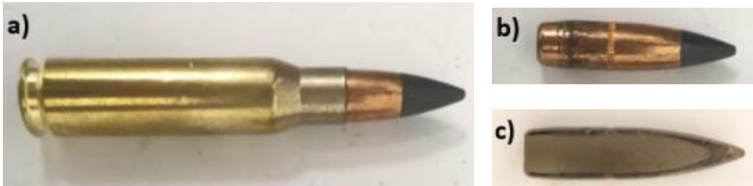
Şekil 2.28. 7,62x51 AP a) Fişek b) Mermi c) Mermi kesit görüntüsü
