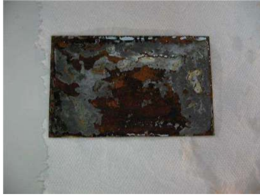
Şekil 6.12 SiC (182 nm) partikül ilaveli çinko kaplama tuz testi 120.saat makro yapısı
