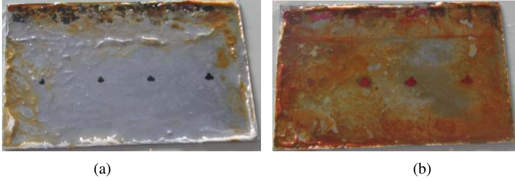
Şekil 6.11 Saf çinko kaplama ve çinko kaplama banyosuna 1 g/l SiC (182 nm) partikül ilavesiyle kaplanan numunelerin tuz püskürtme testi 46 saat sonraki makro yapıları: a) 1 g/l SiC (182 nm) ilaveli numune, b) saf çinko kaplanan numune
