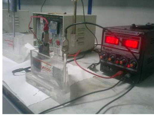
Şekil 6.2 Hull cell düzeneği
