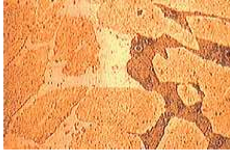
Şekil 2.12 Prinçte seçici korozyonun mikrografik görünümü [21]
