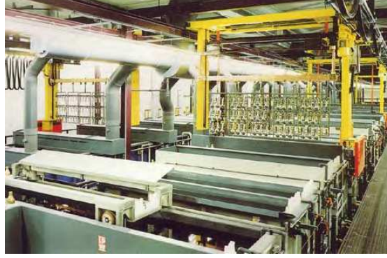
Şekil 4.2 Çinko kaplama tesisi [6]
