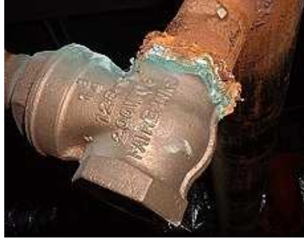
Şekil 2.4 Galvanik korozyona uğramış parça [17]
