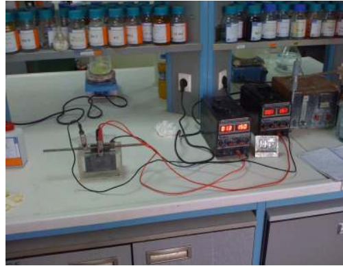
Şekil 6.4 SiC (182 nm) ilaveli çinko kaplama alımında çift taraflı kaplama almak için kullanılan deney düzeneği
