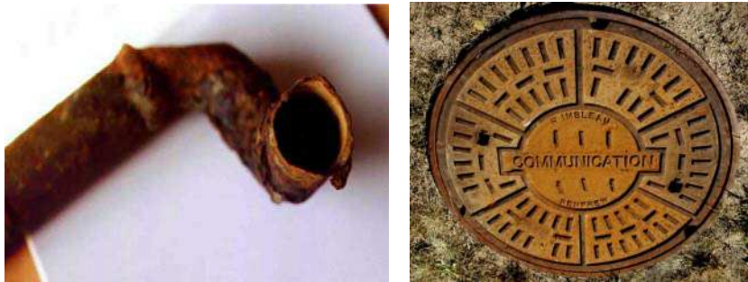
Şekil 2.3 Homojen dağılımlı korozyona uğramış parçalar [16]
