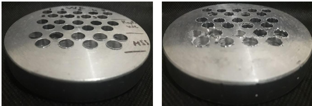
Şekil 3.6. MMK'ların a) delik giriş ve b) delik çıkışlarındaki çapak görüntüleri
