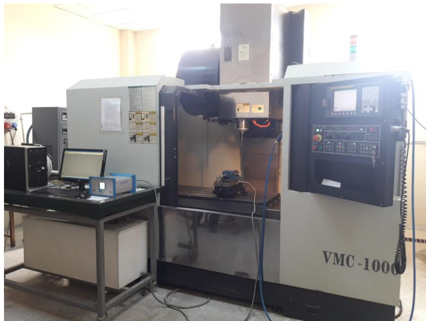
Şekil 3.3. Üç eksenli VMC 1000 CNC dik işleme merkezi
