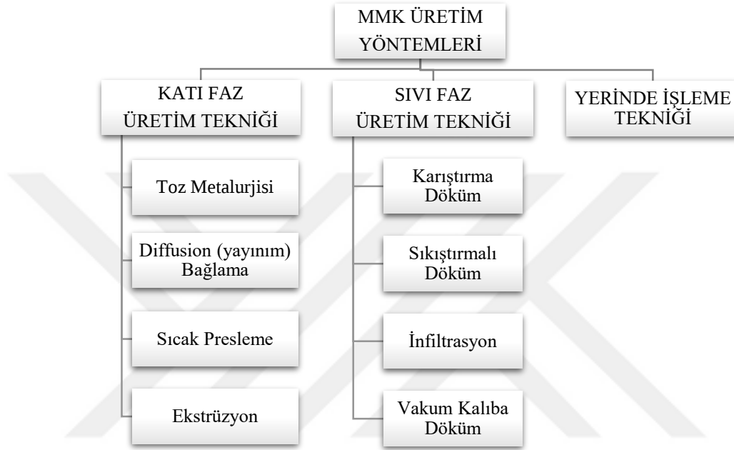
Şekil 2.6. MMK üretim yöntemleri (Arunachalam, 2019)
