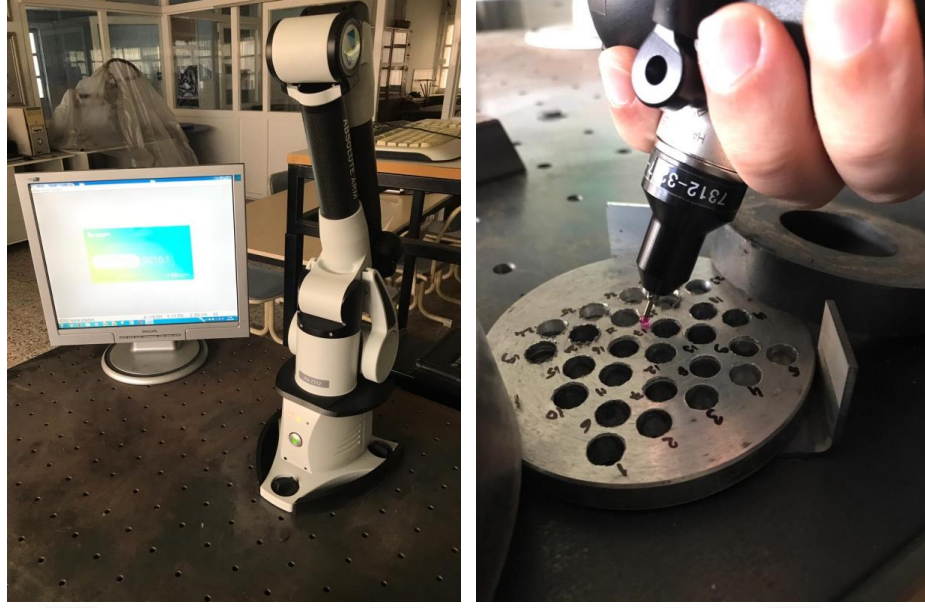
Şekil 3.7. Hexagon Metrology koordinat ölçüm cihazı ve çapak ölçümü
