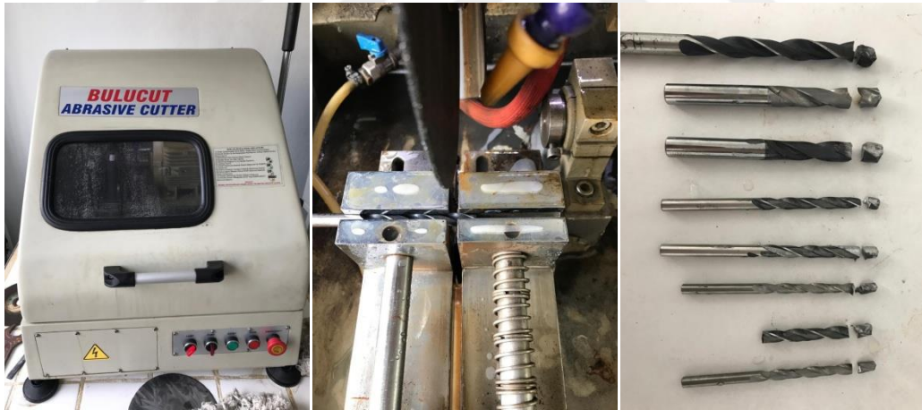
Şekil 3.9. SEM analizi için kesici takımların uygun ölçülere getirilmesi
