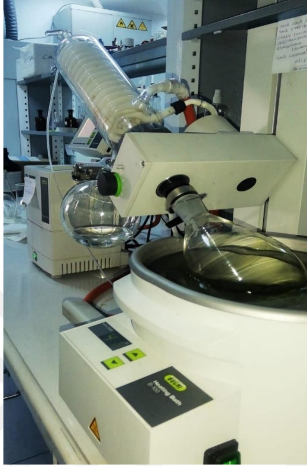
Görsel 3.2. Rotary Evaporator/Rotavapor cihazı (BUCHI, Switzerland)
