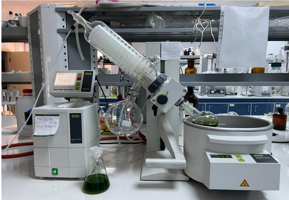
Görsel 3.3. Rotavapor cihazı (BUCHI, Switzerland)
