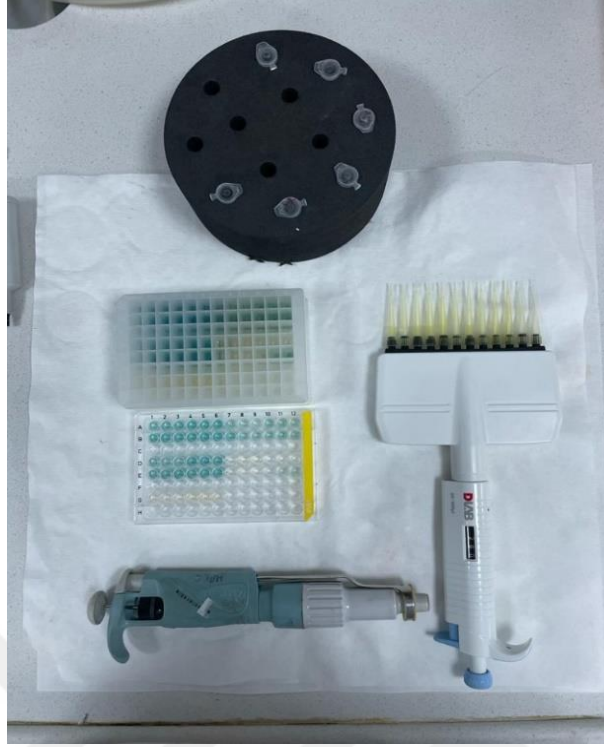
Görsel 3.9. ABTS + radikal katyonu süpürme aktivitesinde kullanılan 96-kuyucuklu mikrotitrasyon plakanın görüntüsü ve kullanılan diğer ekipmanlar
