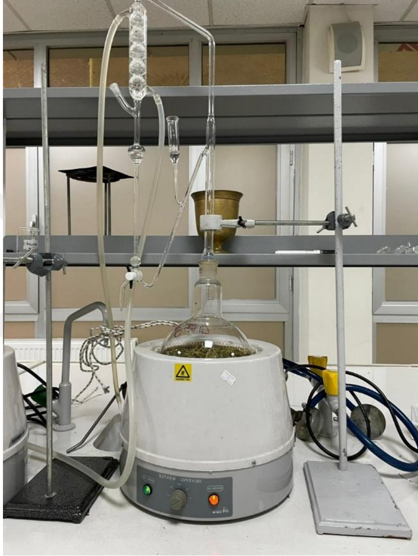
Görsel 3.4. Sideritis montana subsp. montana bitkisinin Clevenger apareyinde su distilasyonu işlemi gerçekleşirken
