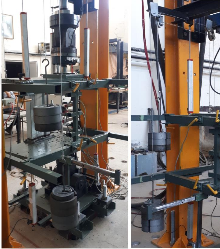
řekil 36. Ykleme levhalarının karşı ađırlıkla dengelenmesi
