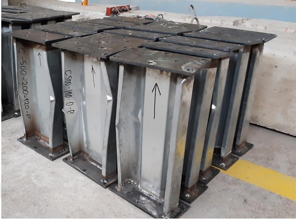
Şekil 85. L=500 mm'lik numunelerin tersinir-tekrarlı deneyler sonrası görünüşleri
