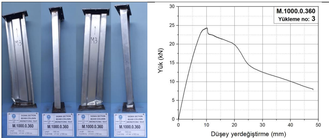
Şekil 66. M.1000.0.360 numunesinin burkulma ve yük-yerdeğiştirme davranışı
