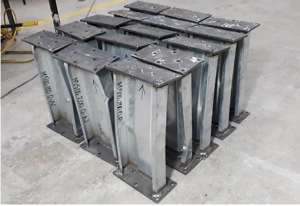
Şekil 53. L=500 mm'lik numunelerin monotonik deneyler sonrası görünümü
