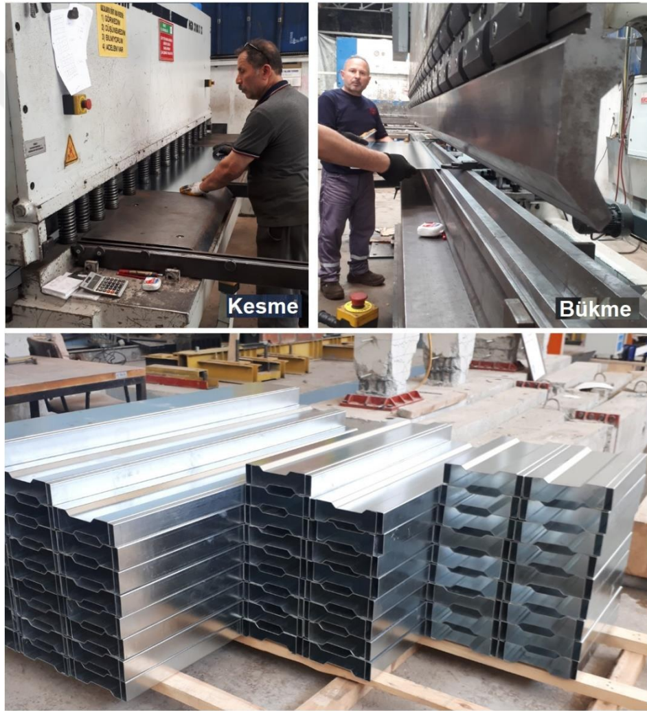
Şekil 28. Sigma profillerin üretimi ve topluca görünümü
