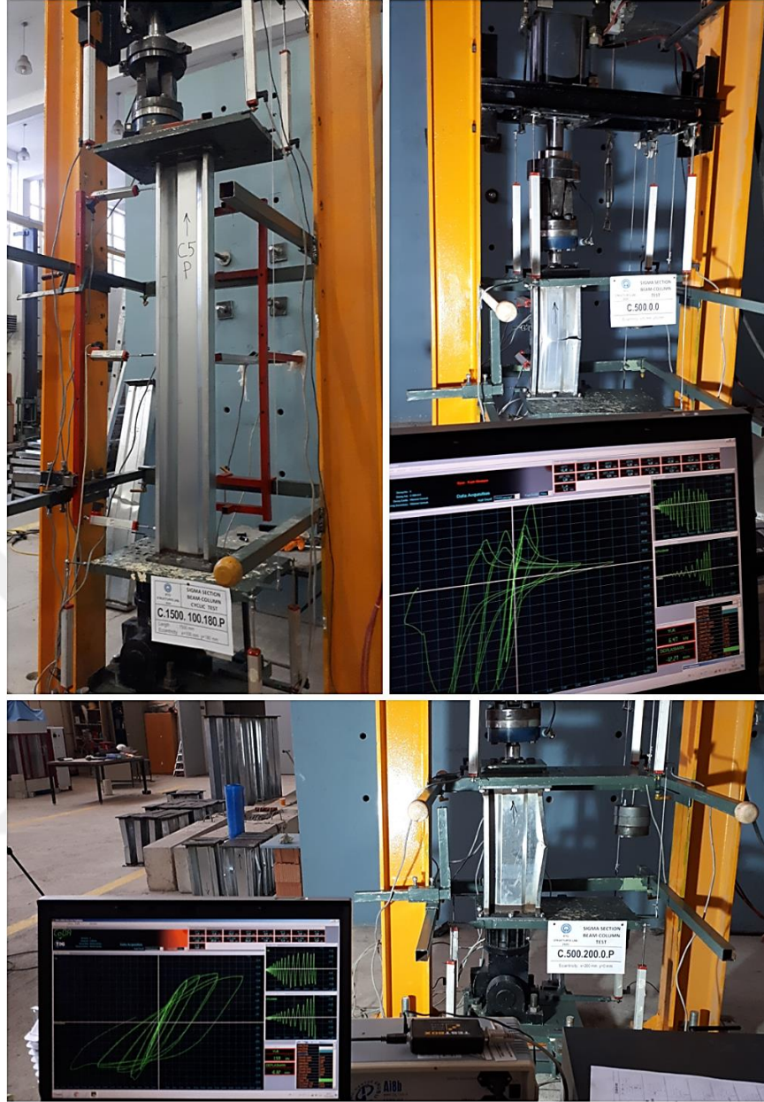
Şekil 83. Tersinir-tekrarlı yükleme deneylerinden görünümeler
