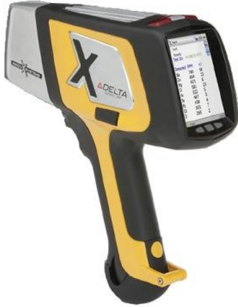
Şekil 12. Batman Üniversitesi Arkeometri Anabilim dalında kullanılan P-EDXRF cihazı
