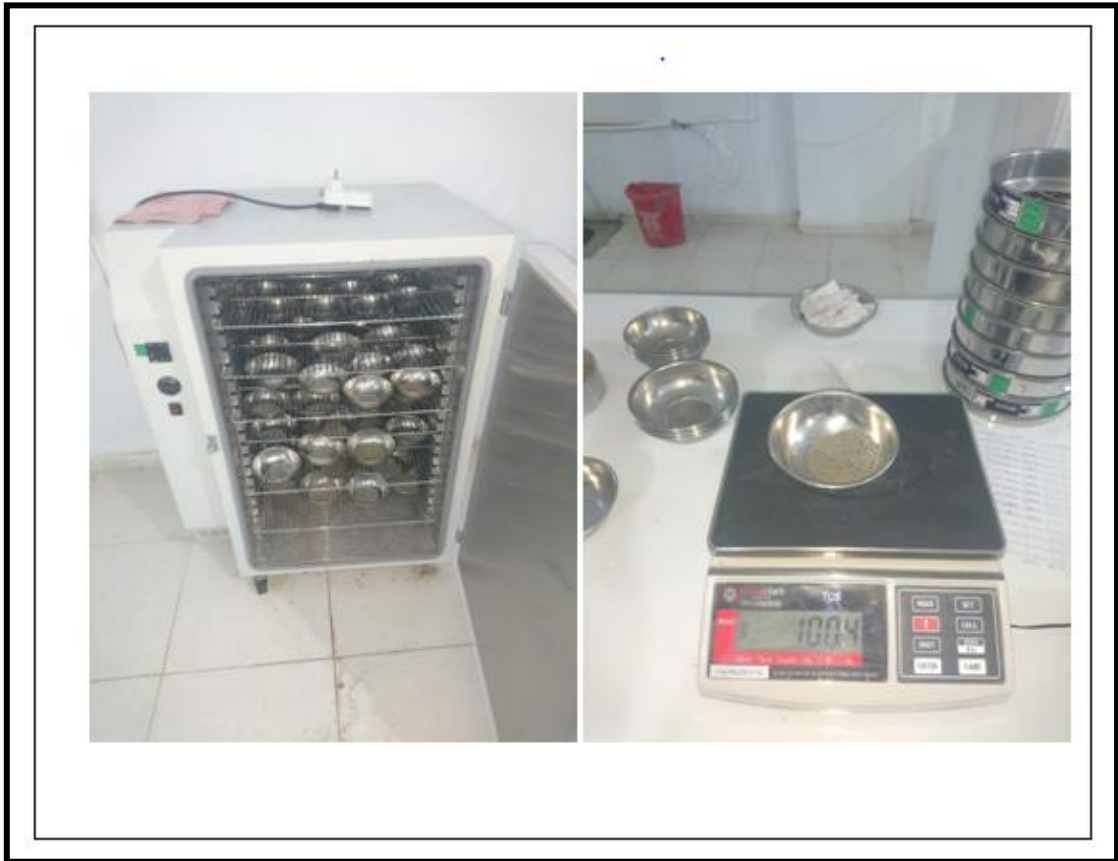
Şekil 4.3. Etüv kurutma yöntemi ile su içeriği belirlenmesi.
