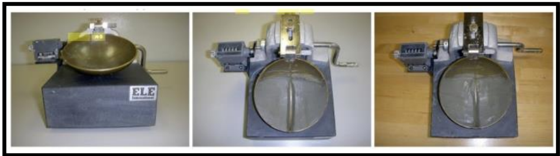
Şekil 4.7. Likit Limit Deney Aleti (Briaud, 2013).
