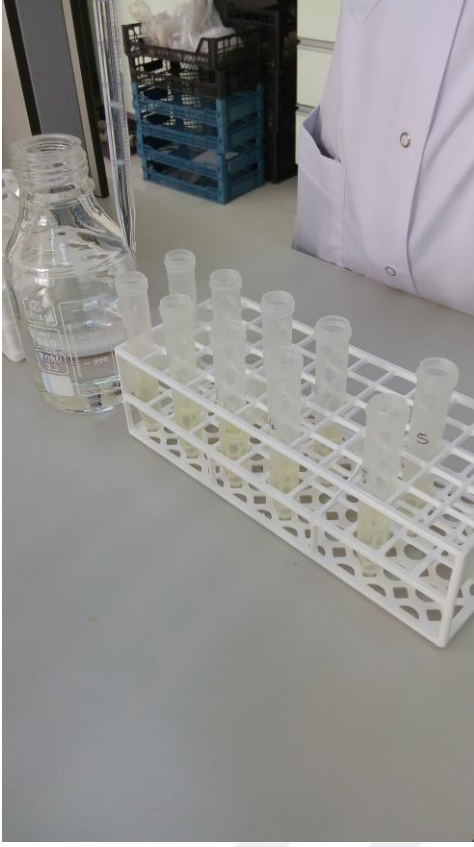
Şekil 3.9. Yüzeyde biriken şeffaf sıvının yeni tüplere nakledilmesi
