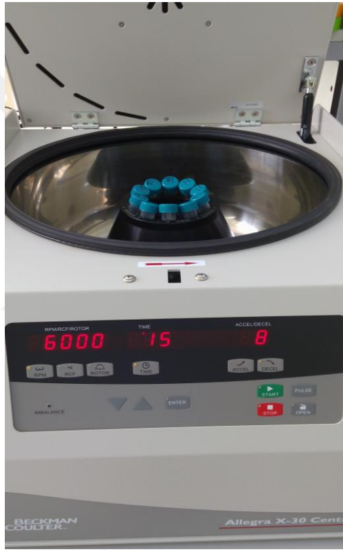
Şekil 3.7. Tüplerin santrifüj cihazına yerleştirilmesi
