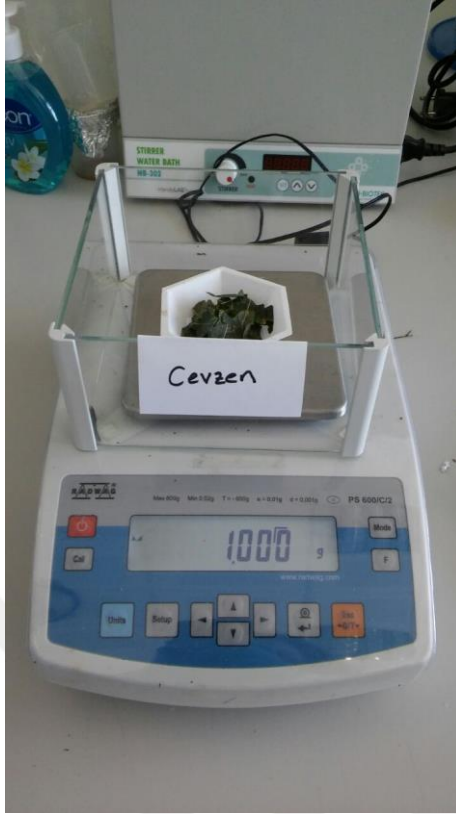
Şekil 3.2. Yaprak numunesinin RADWAG markalı ve 0.001 hassasiyetindeki terazide tartımı
