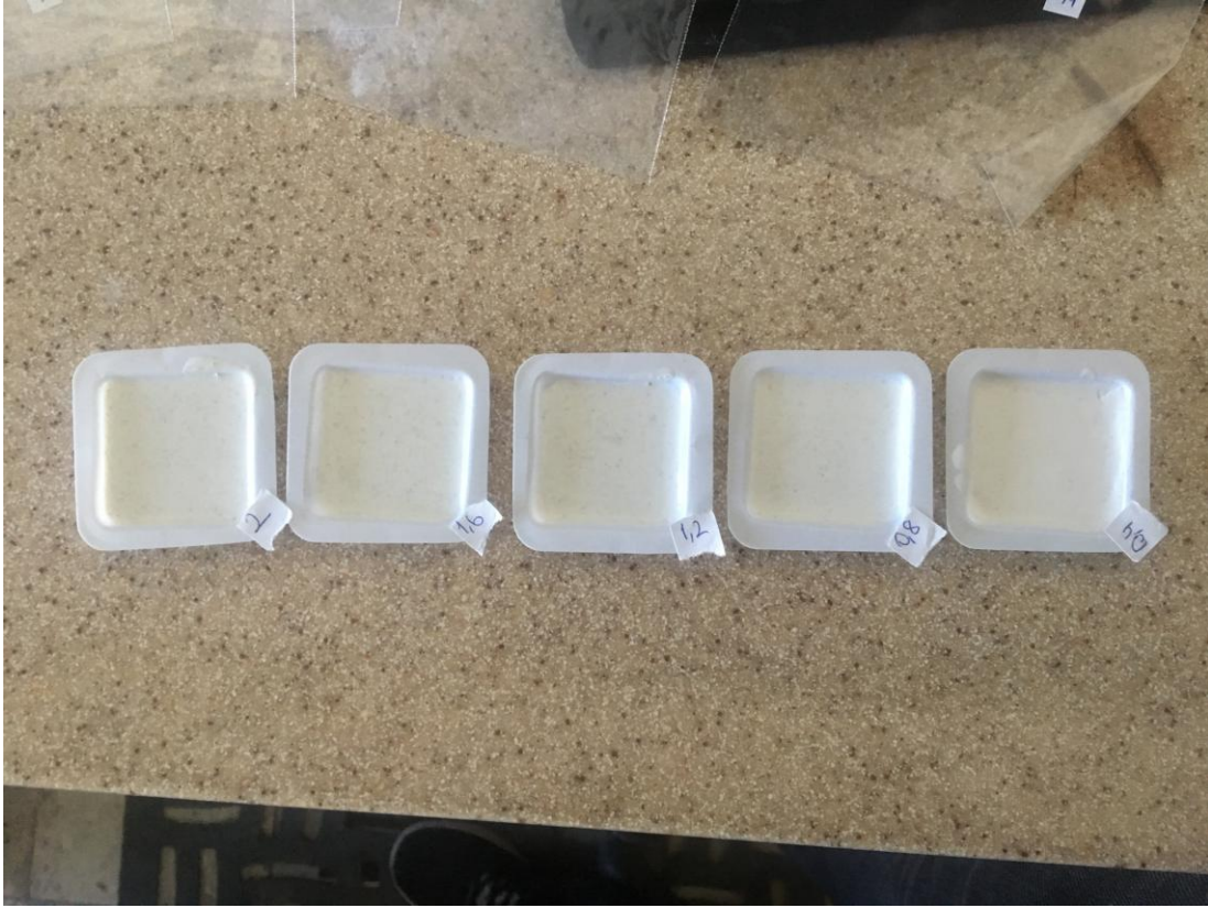
Şekil 3.6 Modifiye edilmiş tozlarla karıştırılmış polimerler.
