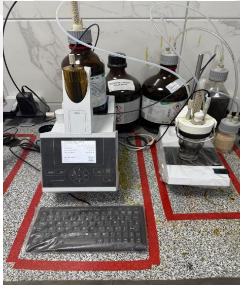
Şekil 3. 4. Titroline® 7500 KF su tayini cihazı
