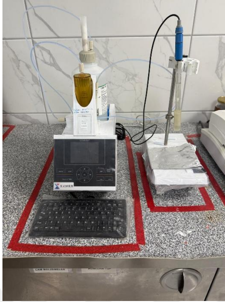
řekil 3. 3. Titroline 7000 NCO titratör cihazı
