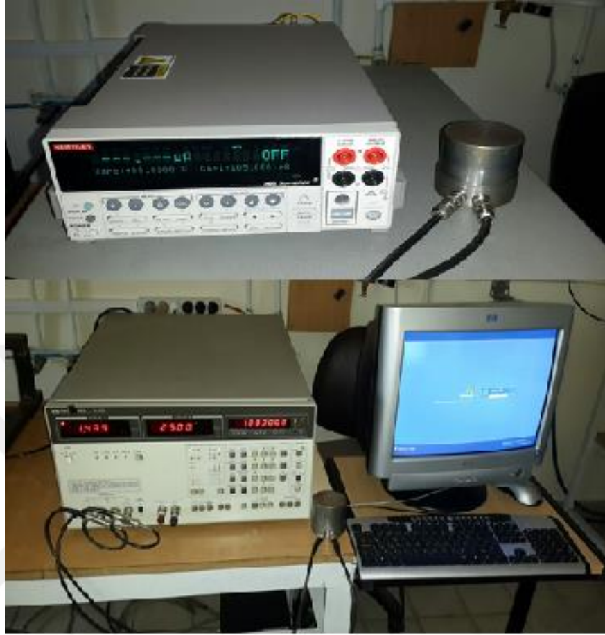
Şekil 3.4. I-V ve C-V ölçümlerinin alındığı sistemler.
