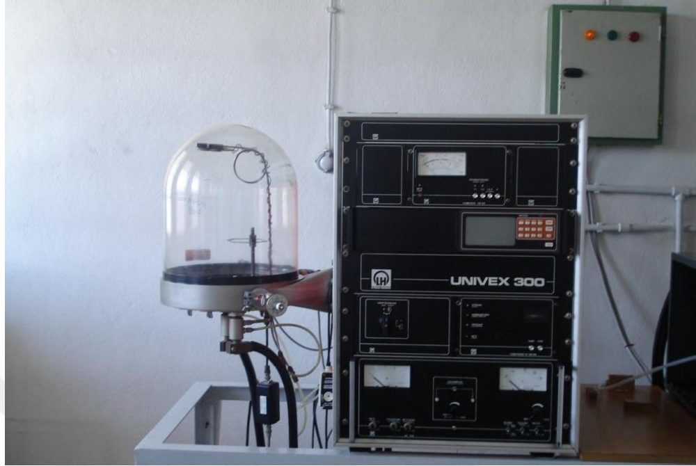
Şekil 3.2. Metal buharlaştırma işlemlerinin yapıldığı kaplama ünitesi
